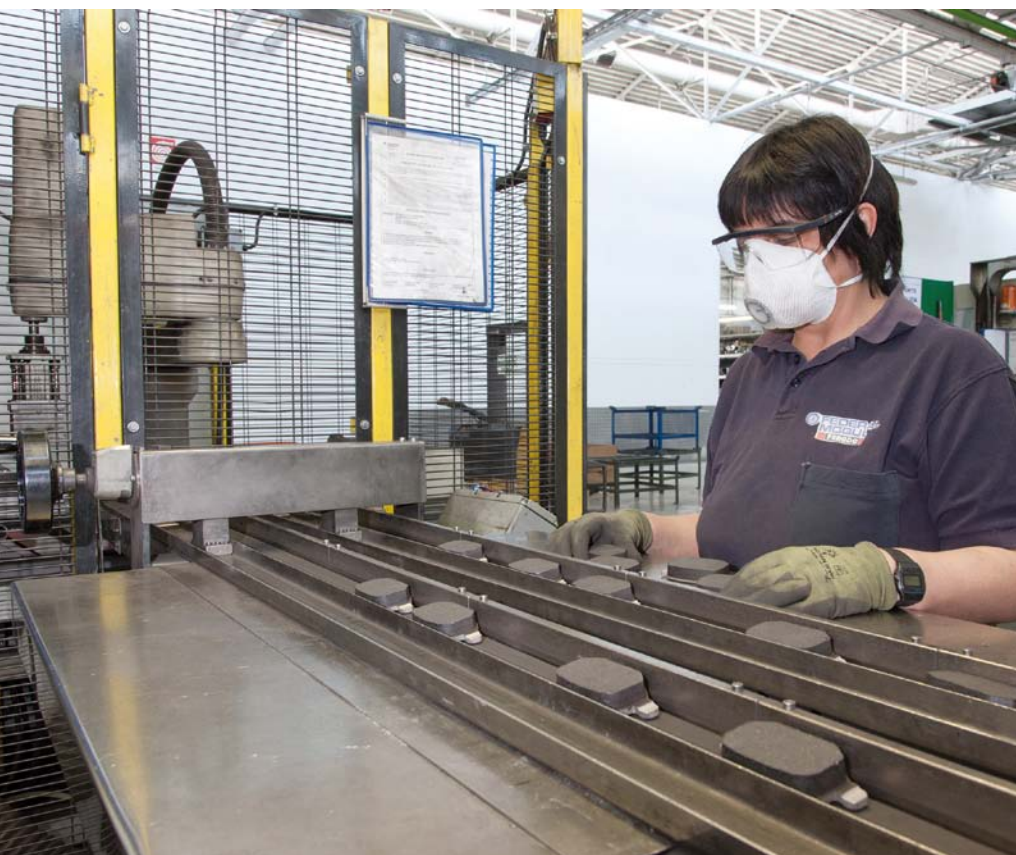
PRODUKCJA KLOCKÓW HAMULCOWYCH NA AUTOMATYCZNYCH LINIACH FABRYKI FEDERAL MOGUL FERODO WE WŁOSKIEJ MONDOVI
