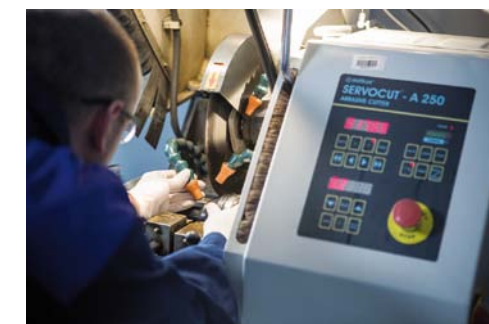
KOMPUTEROWA PRZECINARKA SERVO-CUT-A250 DO PRECYZYJNEGO WYCINANIA PRÓBEK MATE- RIALÓW STALOWYCH
