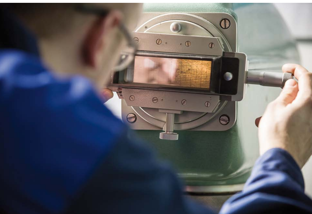
MIKROSKOPOWE BADANIE POWIERZCHNI PRÓBKII W TRAKCIE POMIARU TWARDOŚCI METODĄ VICKERSA
