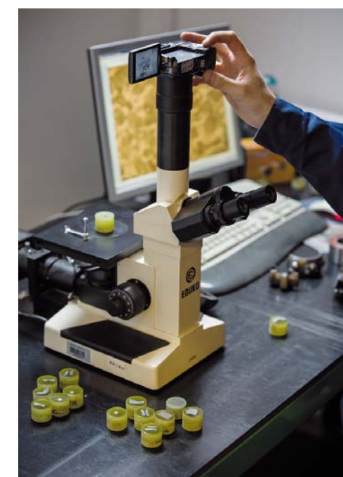
SPRAWDZANIE ZGODNOŚCI STRUKTURY MIKROKRystalicznej badanej próbki z wzorcami polskich norm
