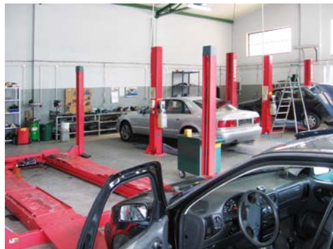
PODNOŚNIK Z PŁYTAMI NAJAZDOWYMI PEŁNI FUNKCJĘ KANAŁU O ZMIENNEJ GŁĘBOKOŚCI
