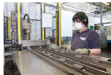
FABRYKA FERODO W MONDOVI: MATERIAŁ CIERNY OSADZONY NA PŁYTKACH NOŚNYCH PRZED DAJSZĄ OBRÓBKĄ
