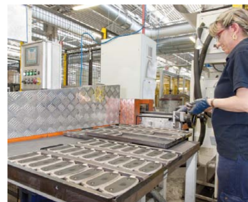
FABRYKA FERODO W MONDOVI: AUTOMATYCZNA LINIA PRODUKCJI KŁOCKÓW HAMULCOWYCH
