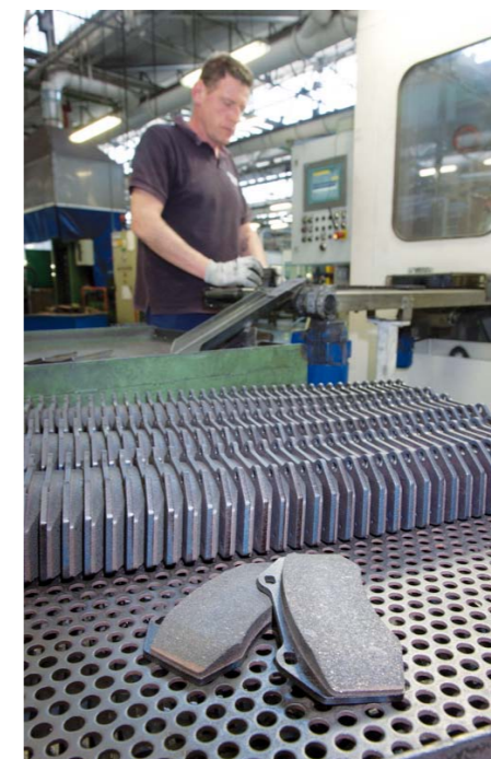
FABRYKA FERODO W MONDOVI: KŁOCKI PO ZUKOSOWANIU SKRAJNYCH STREF MATERIAŁU CIERNEGO
