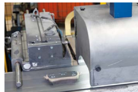
URZĄDZENIE DO OPTYCZNEJ KONTROLI WYMIARÓW KŁOCKÓW HAMULCOWYCH WCHODZĄCE W SKŁAD AUTOMATYCZNEJ LINII ICH PRODUKCJI
