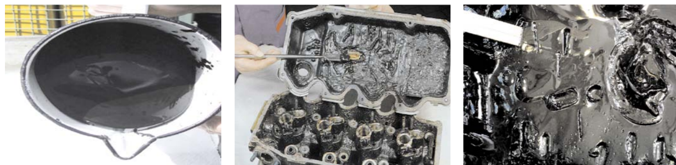
SKUTKIEM UTLENIANIA WĘGLOWODORÓW I WTÓRNYCH REAKCJI PRODUKTÓW TEGO PROCESU SĄ SUBSTANCJE ŻYWICZNE, ZAGĘSZCZAJĄCE OLEJ AŻ DO JEGO CAŁKOWITEGO ZESTALENIA I TWORZĄCE SZKODLIWE OSADY NA WSZYSTKICH SMAROWANYCH POWIERZCHNIACH
