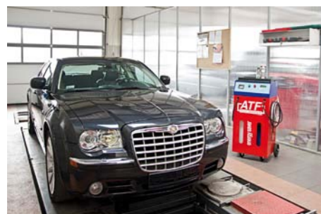
Najpierw należy określić miejsce przyłączenia urządzenia ATF Exchange zalecane przez producenta pojazdu, przeważnie podłącza się je między skrzynią biegów a chłodnicą
