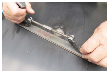
PILNIK BLACHARSKI WYGŁADZA WYPROSTOWANĄ POWIERZCHNIĘ, USUWAJĄC JEJ WYPUKŁOŚCI I UJAWNIAJĄC WKŁĘŚLOŚCI
