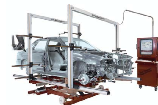
MECHANICZNY SYSTEM WSPÓŁRZĘDNOŚCIOWY Z ELEKTRONICZNYM PRZETWARZANIEM DANYCH
