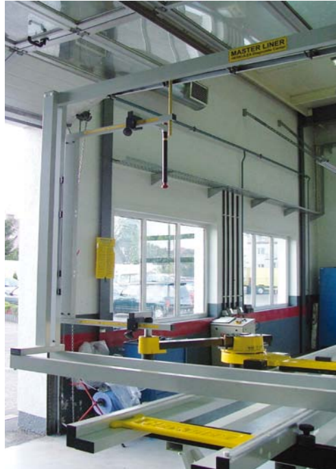
SYSTEM TRYGNOMETRYCZNY Z MECHANICZNYM RAMIENIEM POMIAROWYM
