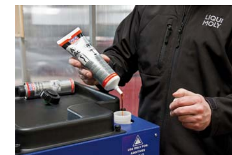
Ostatnią operacją serwisową może być aplikacja preparatu regenerującego uszczelnienia gumowe i plastikowe oraz redukującego ewentualne wycieki oleju (Liqui Moly nr 5135)
