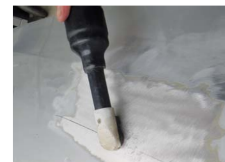
PODGRZEWACZEM INDUKCYJNYM MOŻNA OBKURCZAĆ ROZLEGŁE WGNIECENIA LUB GRZAĆ JE PRZED PROSTOWANIEM MECHANICZNYM
