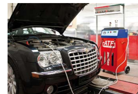
Po skończonym procesie czyszczenia skrzyni biegów ATF Exchanger automatycznie przechodzi do wymiany oleju, a potem sygnalizuje zakończenie tej czynności
