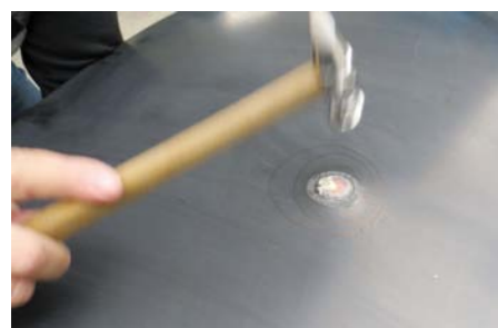
...NIERDZEWNEGO MŁOTKA UŻYTEGO WRAZ Z KLEPADŁEM DO WSTĘPNEGO ROZPŁASZCZENIA ROZGRZANYCH NIERÓWNOŚCI
