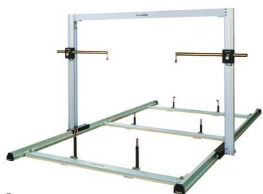
PROSTY MECHANICZNY SYSTEM DO KONTROLI GEOMETRII NADWOZI
