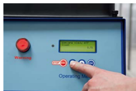
Przy metodzie dynamicznej do wymiany należy użyć o ok. 2 litrów oleju więcej, niż wynosi pojemność skrzyni biegów, by napelnić ją wyłącznie świeżym środkiem smarnym
