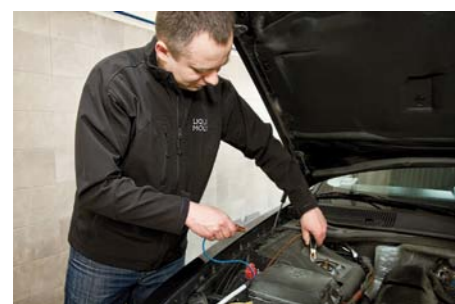
Po zmontowaniu obiegu wymiany należy podłączyć ATF Exchanger do źródła prądu. Urządzenie jest zasilane stałym napięciem 12 V, czyli z akumulatora obsługiwanej pojazdu
