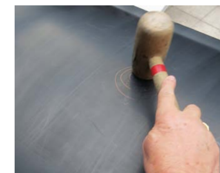
PROSTOWANIE MŁOTKIEM ROZPOCZYNA SIĘ NA OBWODZIE ZAGŁĘBIENIA I PROWADZI SPIRALNIE KU JEGO ŚRODKOWI
