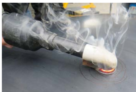
USUWANIE NADMIARU MATERIAŁU ZGROMADZONEGO W ŚRODKOWEJ CZĘŚCI WGNIECENIA ZA POMOCĄ PODGRZEWACZA INDUKCYJNEGO I ...
