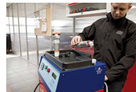
Urządzenie umożliwia też dodatkowe czyszczenie przekładni automatycznej odpowiednim produktem, np. Liqui Moly nr 2512, który należy wlać do specjalnego zbiorniczka
