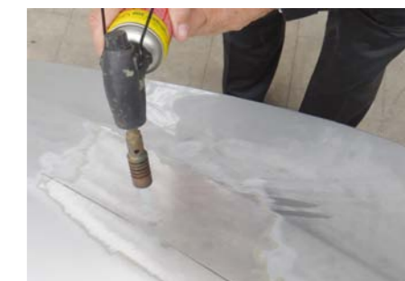
PODGRZEWANIE BLACHY PALNIKIEM NA PROPAN-BUTAN. CIEMNA LINIA ZNIKA PO UZYSKANIU WŁAŚCIWEJ TEMPERATURY
