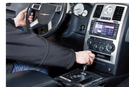
Podczas 10-minutowego procesu czyszczenia przekładni automatycznej konieczne jest kolejne włączenie co kilka sekund wszystkich dostępnych pozycji dźwigni zmiany przełożeń
