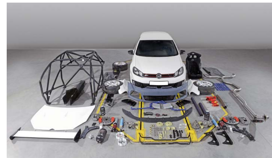
ELEMENTY DODANE I ZMODYFIKOWANE, RÓŻNIĄCE SAMOCHÓD WYCZYNOWY OD SERyjNEGO
