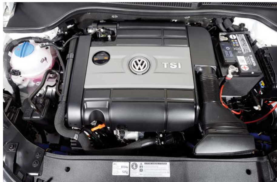
DWULITROWY SILNIK O MOCY ZWIĘKSZONEJ Z 210 DO 260 KM POPRZECZMIANĘ PROGRAMU W ELEKTRONICZNEJ JEDNOSTCE STERUJĄCEJ
