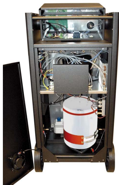
WNĘTRZE STACJI OBSŁUGOWEJ DO R1234YF: W GÓRNEJ, ODDZIELNEJ CZĘŚCI OBUĐOWY ZAINSTALOWANY JEST DODATKOWY WENTYLATOR
