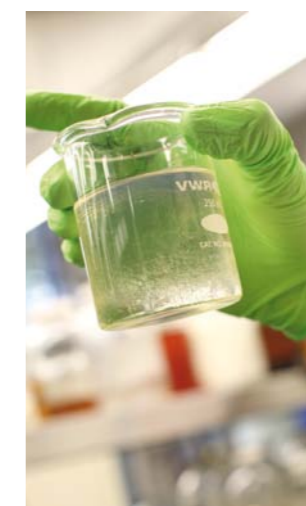
BADANIE ROZPUSZCZALNOŚCI OLEJÓW METODĄ TWORZENIA PRÓBNYCH ROZTWORÓW
