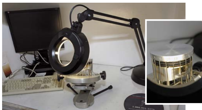
SILNIK GM ECOTEC W TRAKCIE TESTÓW: ELEMENTY TESTOWANEGO SILNIKA (GŁOWICA I MECHANIZM ZAWOROWY) ZDEMONTOWANE PO ZAKOŃCZENIU PRÓBY: STANOWISKO DO WIZUALNEJ OCENY CZYSTOŚCI TŁOKÓW WYMONTOWANYCH Z TESTOWANEGO SILNIKA
