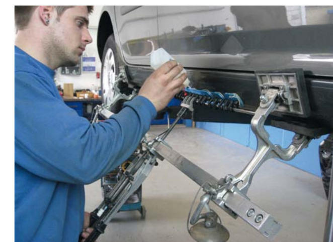
NAPRAWA WGNIECENIA PROGU METODĄ ZACZEPÓW KLEJONYCH MIRACLE
