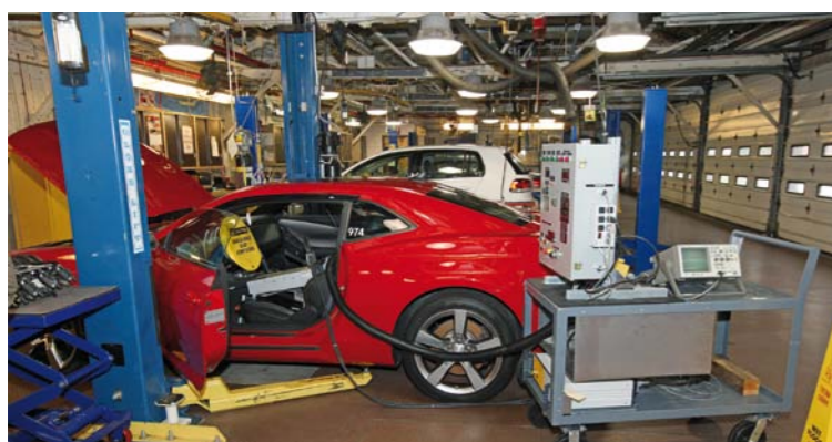
SAMOCHÓD NA HAMOWNI PODWOZIOWEJ ODTWARZAJĄCEJ W CYKLU TESTÓW RZECZYWISTE WARUNKI PRACY OLEJU PODCZAS DŁUGIEGO PRZEBIEGU (200-300 TYSIĘCY KM)
