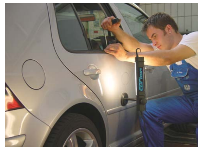
PROSTOWANIE WGNIECENIA POSZYCIA DRZWI NARZĘDZIEM Z ZESTAWU SMART REPAIR
