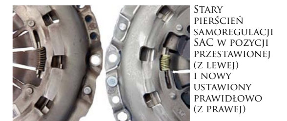
ELEMENTY SYSTEMU SAMOREGULACJI DOCISKU SPRZĘGŁA
