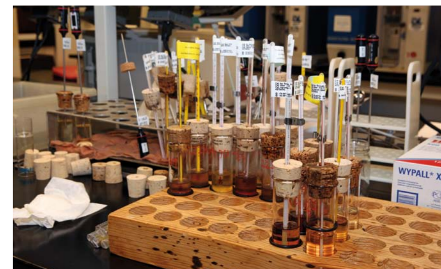
STANOWISKA LABORATORYJNE DO: – AUTOMATYCZNEGO BADANIA LEPKOŚCI KINEMATYCZNEJ ZGODNIE Z NORMĄ ASTM D445 (U GÓRY Z LEWEJ) – ROTACYJNEGO BADANIA LEPKOŚCI WEDŁUG NORMY MRV – ASTM D4684 (U GÓRY Z PRAWYJ) – POMIARU TEMPERATURY PEŁNIENIA OLEJÓW WEDŁUG NORMY ASTM D97 (U DOŁU Z PRAWYJ)
