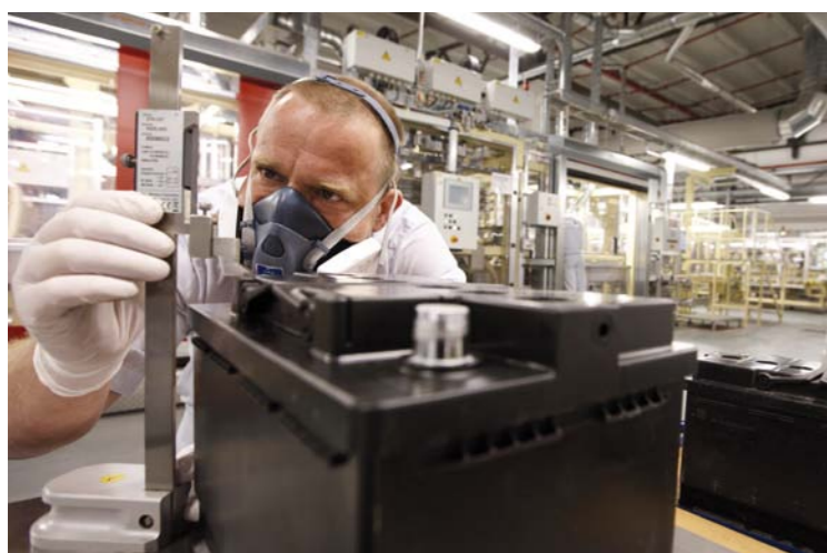
STANOWISKO OSTATECZNEJ KONTROLI WYMIARÓW ZEWNĘTRZNYCH ZMONTOWANEGO AKUMULATORA
