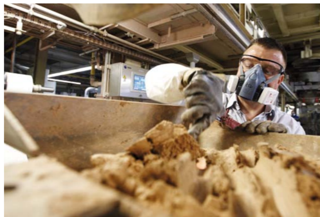
LINIA PRZYGOTOWYWANIA TZW. MASY CZYNNEJ DO WYPEŁNIENIA KRATEK ELEKTROD
