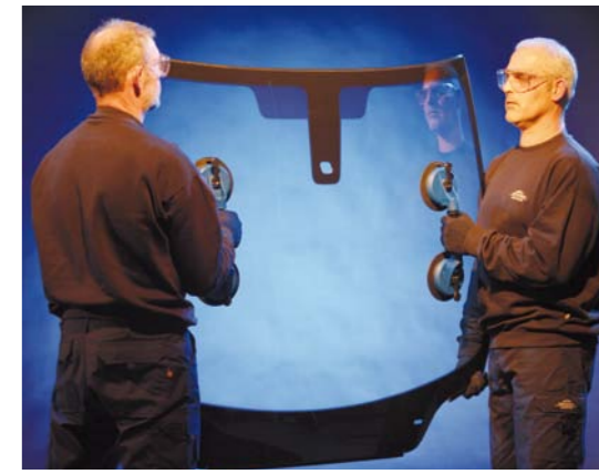
UCHWYTY PODCIŚNIENIOWE UMOŻLIWIĄJĄ TEŻ BEZPIECZNY TRANSPORT SZYB W OBRĘBIE ZAKŁADU
