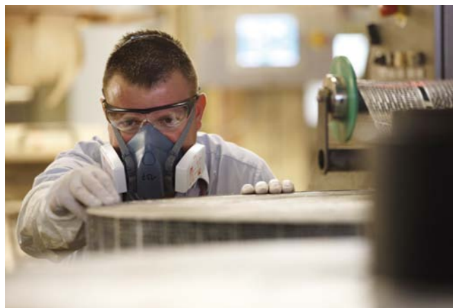
KRATKI ELEKTROD DOSTARCZANE SĄ DO MONTAŻU W FORMIE OŁOWIANEJ TAŚMY, PERFOROWANEJ METODĄ POWERFRAME®
