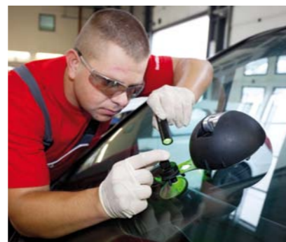
NAPRAWA UBYTKÓW ŻYWICĄ DAJE DOBRE EFEKTY PRZY ŚWIEŻYCH USTERKACH
