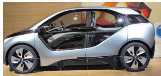
STUDYJNY MODEL BMW i3 Z ALUMINIOWĄ PŁYTĄ PODŁOGOWĄ I NADWOZIEM Z KOMPOZYTU WZMACNIANEGO WŁÓKNEM WĘGLOWYM
