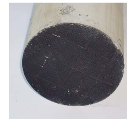
WKŁAD DPF NIEMAL CAŁKOWICIE NIEDROŻNY, WYMAGAJĄCY WYMIANY
