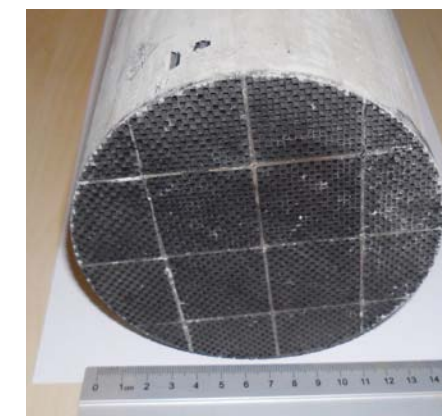
WKŁAD ZANIECZYSZCZONY, WYMAGAJĄCY REGENERACJI WYMUSZONEJ
