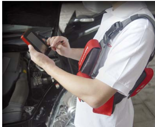
ZMINIATURYZOWANA WERSJA TESTERA X-431 DIAGUN Z TRANSMISJĄ BEZPRZEWODOWĄ
