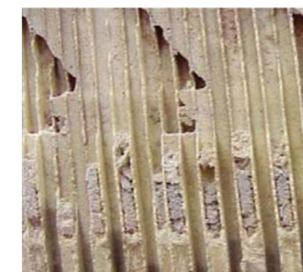
ZABLOKOWANIE WKŁADU POPIOŁEM Z DODATKÓW USZLACHETNIAJĄCYCH OLEJU
