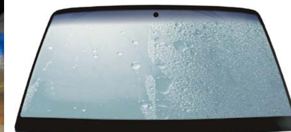
Z LEWEJ: WIDOK PRZEZ HYDROFOBIZOWANĄ SZYBĘ PODCZAS JAZDY W DESZCZU. POWYŻEJ: PORÓWNANIE SZYBY PO I PRZED ZABIEGIEM HYDROFOBIZACJI
