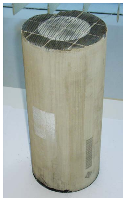
CERAMICZNY WKŁAD FILTRUJĄCY IZOLOWANY TERMOWŁÓKNINĄ, UMIESZCZANY W METALOWEJ OBUDOWIE
