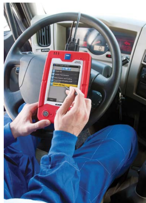
SZYBKA KONTROLA POJAZDU UŻYTKOWEGO WYKONYWANA ZE STANOWISKA KIEROWCY
