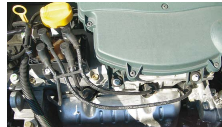
WIĄZKA PRZEWODÓW ZAPŁONOWYCH ZAMONTOWANA W SILNIKU PRZY UŻYCIU ELEMENTÓW SPINAJĄCYCH, MOCUJĄCYCH, PROWADZĄCYCH I OSŁONOWYCH
