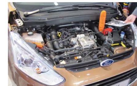
...WYJĄTKOWO EKONOMICZNY I EKOLOGICZNY SILNIK NOWEJ GENERACJI – FORD ECOBOOST, KTÓRY PRZY POJEMNOŚCI 1000 CCM MA MOC 120 KM
