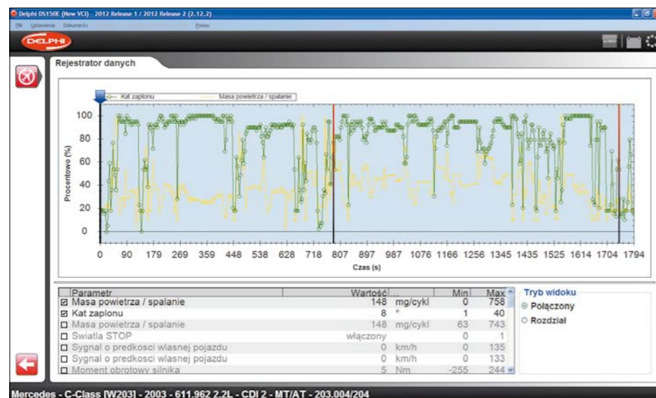
PARAMETRY RZECZYWISTE ZAPISANE PRZEZ REJESTRATOR FLIGHT RECORDER MOGA BYĆ WYŚWIETLANE W FORMIE WYKRESU LUB/I LISTY
