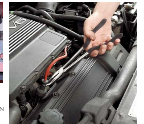
WIĄZKA PRZEWODÓW ZAPŁONOWYCH ZAMONTOWANA W SILNIKU PRZY UŻYCIU ELEMENTÓW SPINAJĄCYCH, MOCUJĄCYCH, PROWADZĄCYCH I OSŁONOWYCH
