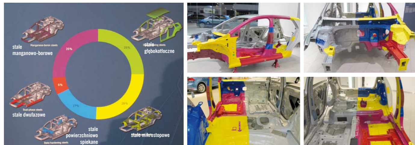
STRUKTURA MATERIAŁOWA NADWOZIA VW GOLF VII, NA SŁUPKU B WIDOCZNE SĄ EFEKTY METODY TAILORED TEMPERING
