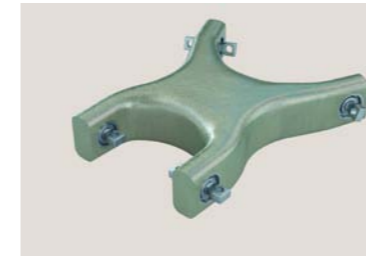
PROTOTYP CZTEROPUNKTOWEGO WAHACZA WYKONANEGO Z PLASTIKU WZMACNIANEGO WŁÓKNEM SZKLANYM
