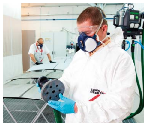
SZLIFOWANIE MIĘDZYWARSTWOWE WYKONUJE SIĘ NA SUCHO. PAPIERAMI O ZALECANEJ GRADACJI ŚCIERNIWA I PO DOKŁADNYM WYSUSZENIU JUŻ NANIESIONEJ WARSTWY
