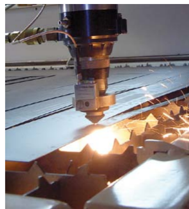
OD LEWEJ: CIĘCIE LASEROWE BLACH O GRUBOŚCI 5 MM, CIĘCIE LASEROWE BLACH CIENKICH, GŁOWICA LASEROWA PODCZAS CIĘCIA STALI WYSOKOSTOPEWYJ – WIĄZKA JEST NIEMAL NIEMAL NIEWIDOCZNA
