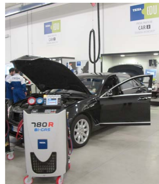
PRZYSTOSOWANY DO DWÓCH RODZAJÓW CZYNNIKA CHŁODNICZEGO WSPÓŁCZESNY MODEL STACJI 780 R BI-GAS W DZIALE SZKOLENIOWYM TEXAEDU
