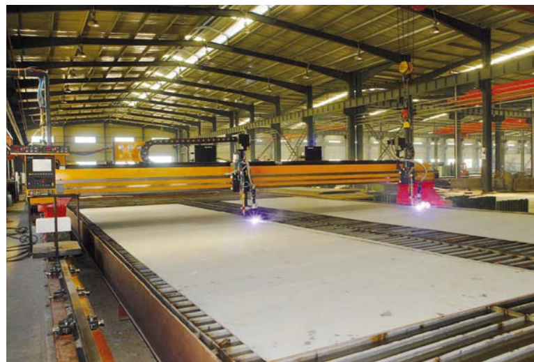
Z LEWEJ: CIĘCIE PLAZMOWE ELEMENTÓW WIELKOGABARYTOWYCH ZA POMOCĄ DWUGŁOWICOWEGO URZĄDZENIA PORTALOWEGO. POWYŻEJ: DRAŻARKO-SPAWARKA ELEKTRONOWA Z KOMORĄ WYSOKIEJ PRÓŻNI
