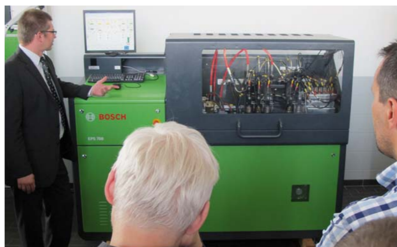
PREZENTACJA UNIWERSALNEGO TESTERA WTRYSKIWACZY EPS 708
