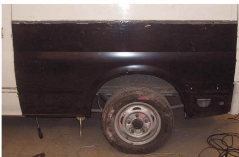
BOCZNY PŁAT ZEWNIĘTRZNEGO POSZYCIA WYMIENIONY METODĄ KLEJENIA
