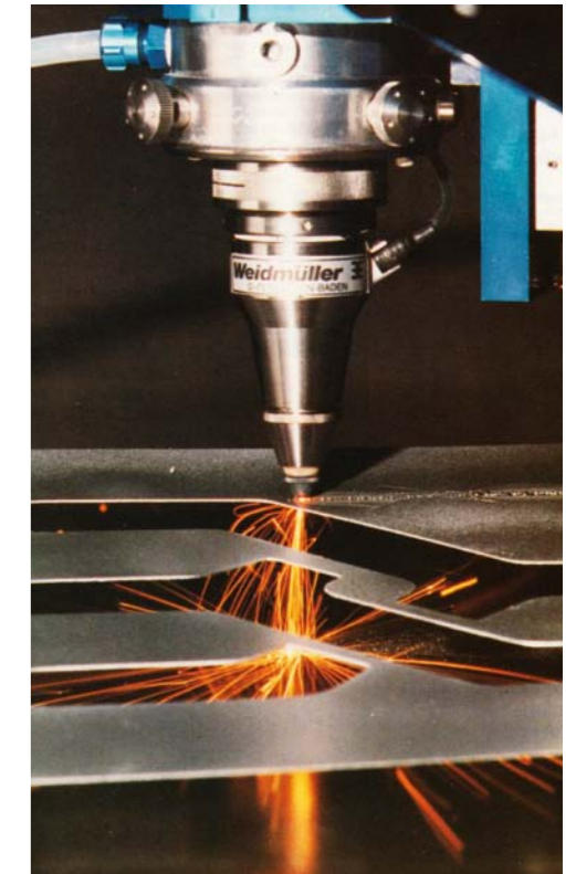
PLAZMOWE CIĘCIE STALI WYSOKOSTOPOWEJ
