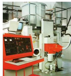
Z LEWEJ: CIĘCIE PLAZMOWE ELEMENTÓW WIELKOGABARYTOWYCH ZA POMOCĄ DWUGŁOWICOWEGO URZĄDZENIA PORTALOWEGO. POWYŻEJ: DRAŻARKO-SPAWARKA ELEKTRONOWA Z KOMORĄ WYSOKIEJ PRÓŻNI
