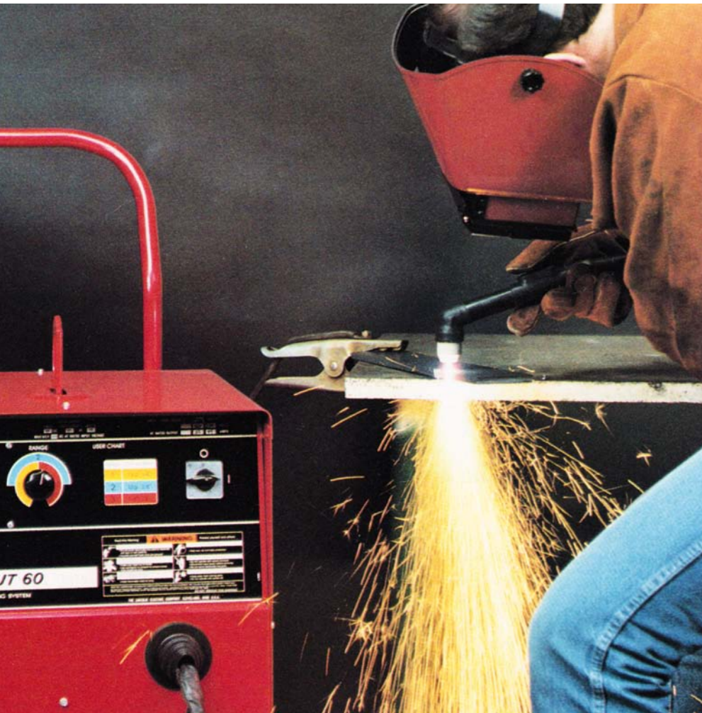
RĘCZNE CIĘCIE PLAZMĄ POWIETRZNĄ
