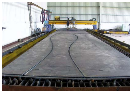
WYCINANIE KSZTAŁTOWE ELEMENTU WIELKOGABARYTOWEGO
