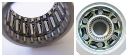
PORÓWNANIE WEWNĘTRZNEJ KONSTRUKCJI PRODUKTU MARKI INA (Z LEWEJ) I JEGO „TAŃSZEGO ZAMIENNIKA”
