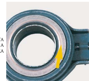
PRZESUNIĘCIA KĄTOWE (1) LUB RÓWNOLEGŁE (2) POMIĘDZY SILNIKIEM A SKRZYNIĄ BIEGÓW
