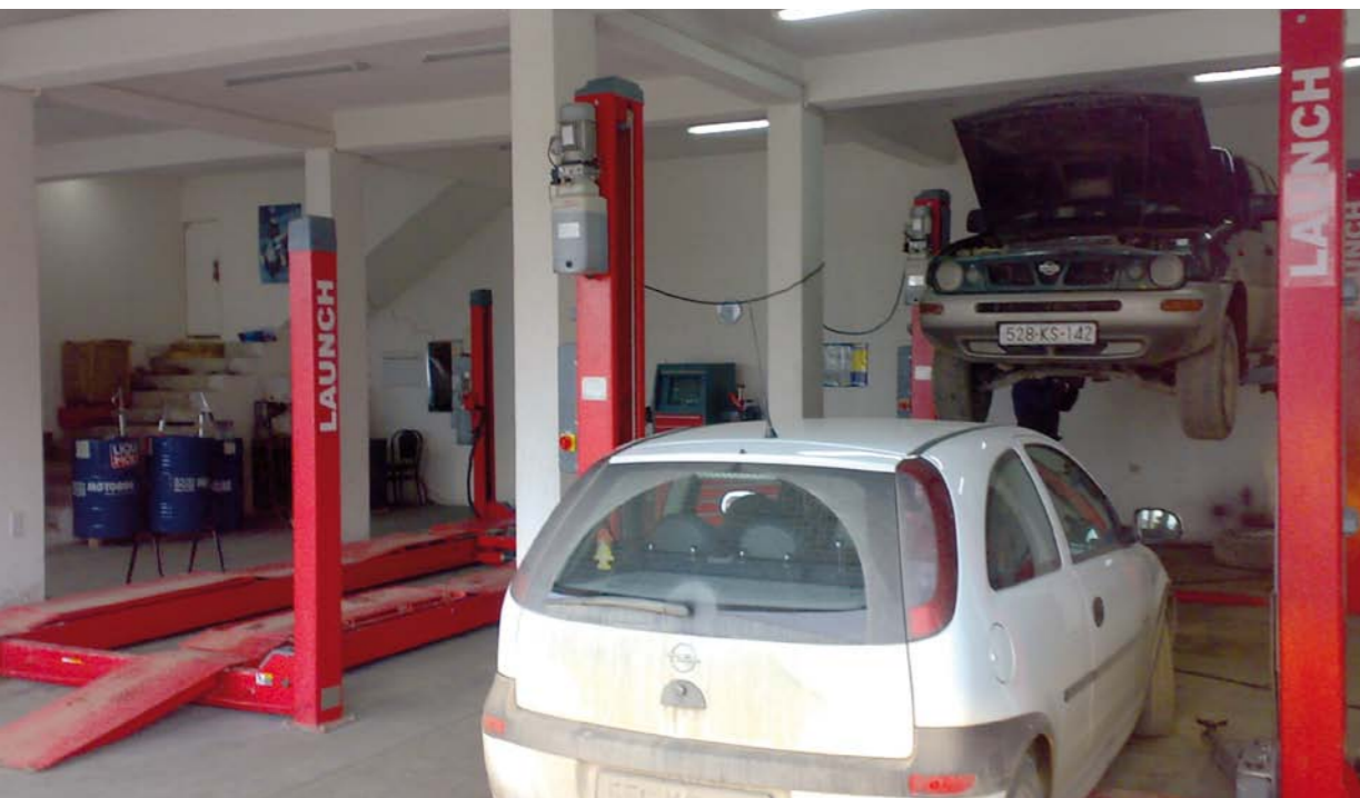
STANOWISKO O STANDARDOWYCH WYMIARACH MOŻE PRZY ODPOWIEDNIEJ ORGANIZACJI PRACY I ZAINSTALOWANIU DRUGIEGO PODNOŚNIKA OBSŁUGIWAĆ PO DWA POJAZDY RÓWNOCZEŚNIE
