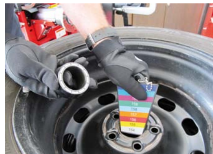
4. Dobór właściwego stożka do otworu felgi ułatwia prosty wzornik
