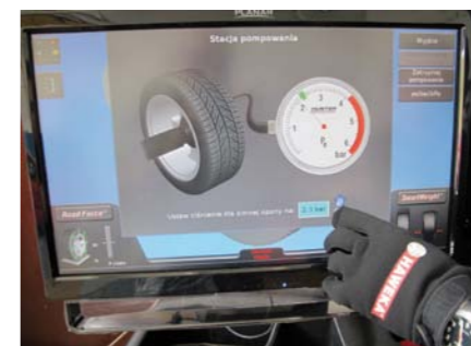
11. Przed badaniami obejmującymi też test sztywności opony trzeba uregulować panujące w niej ciśnienie powietrza za pomocą zintegrowanego inflatora
