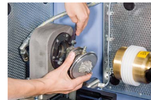
ZMONTOWANY RDZEŃ TURBOSPŔĘŻARKI W WYSOKOOBROTOWEJ WYWAŻARCE SCHENCK 110MBS
