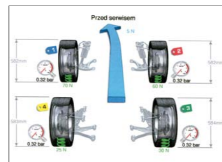
22 i 23. Wydruk zalecanej optymalizacji (eliminacja ściągania w lewo) rozmieszczenia diagnozowanych kół w samochodzie
