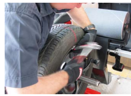
16. Ciężarek po stronie zewnętrznej (gdz jest on potrzebny) mocuje się również według danych z ekranu i laserowej linii na kole
