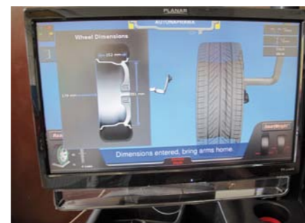
10. ...by po samoczynnym obrocie koła odczytać niezwłocznie wyniki na ekranie
