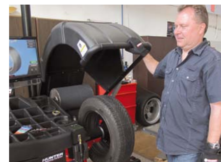
12. Opuszczenie ostony koła uruchamia procedury pomiarowe, których wyniki pojawiają się kolejno na ekranie. Cały cykl pomiarów trwa ok. 20 sekund
