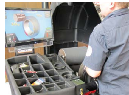
15. Lokalizację i masę ciężarków można zoptymalizować, uruchamiając na ekranie funkcję SmartWeight
