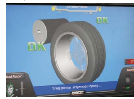
17. Po usunięciu niewyważenia urządzenie bada rolką dociskową jednorodność sztywności opony i sprawdza, czy mieści się ona w dopuszczalnym zakresie
