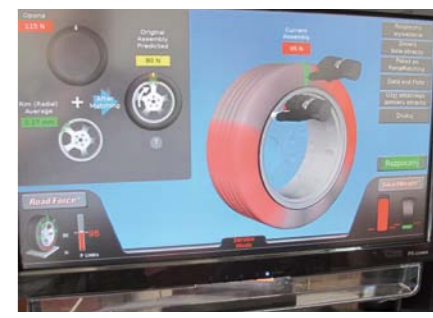
18. Dyskwalifikacja opony z powodu jej zbyt niejednorodnej sztywności
