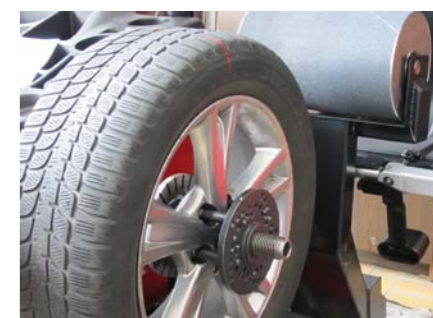
24. Do kół z alufelgami służy specjalny system mocowania ich na wrzecionie i program rozmieszczający klejone ciężarki za szprychami
