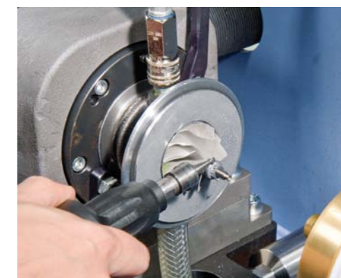
KOREKTA NIETYWAŻENIA BEZPOŚREDNIO NA WYWAŻARCE
