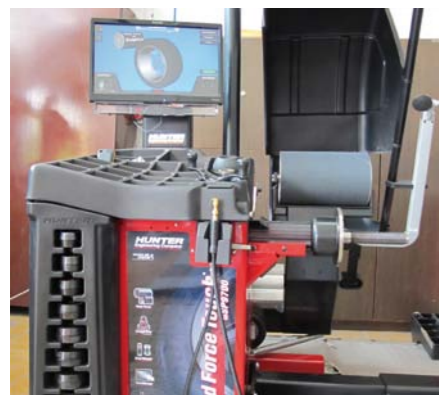
1. Brak tu sterowniczego pulpitu. Wszystkie funkcje są uruchamiane dotykiem odpowiednich stref ekranu ręką (nawet w grubej i brudnej rękawicy)
