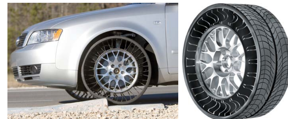
FIRMA MICHELIN OPRACOWAŁA PROTOTYP OGUMIENIA O NAZWIE TWEED, W KTÓRYM ELASTYCZNE TWORZYWO ZASTĘPUJE SPRĘŻONE POWIETRZE
