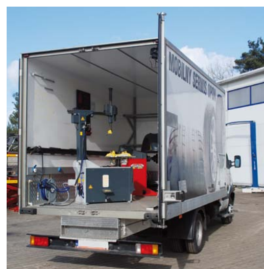
SAMOCHÓD MOBILNEGO SERWISU OGUMIENIA Z WŁASNĄ AGREGATĄ PRĄDOWŁÓRCZĄ I MOŻLIWOŚCIĄ PODŁĄCZENIA DO SIECI ENERGETYCZNEJ
