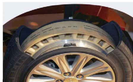
ROZWIĄZANIA UMOŻLIWIĄJĄCE DOJAZD DO SERWISU PO UTRACIE CIŚNIENIA: OD LEWEJ PRZEKRÓJ KOŁA TYPU PAX MICHELINA, OPONY RUN ON FLAT GOODYERA I KONSTRUKCJI CSR CONTINENTALA (DODATKOWY PIERŚCIEŃ NOŚNY WSPÓŁPRACUJĄCY ZE STANDARDOWĄ FELGĄ I OPONĄ
