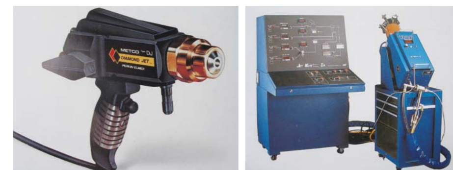
PISTOLET DO METALIZACJI NATRYSKOWEJ I JEGO TECHNOLOGICZNE ZAPLECZE (Z PRAWY) TO SPRZĘT KOSZTOWNY I WYMAGAJĄCY SPECJALISTYCZNEJ OBSŁUGI
