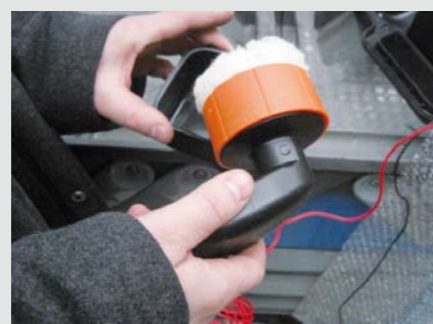
Nasączenie tamponu elektrolitem
