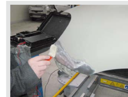
Początek cynkowania głównego
