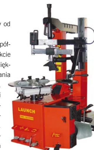
MONTAŻOWNICA Z PRZYSTAWKĄ DO OPON NISKO-PROFILOWYCH. NAZYWANA AUTOMATYCZNĄ DLA ODRÓŻNIENIA OD MNIEJ ZAAWANSOWANYCH KONSTRUKCJI
