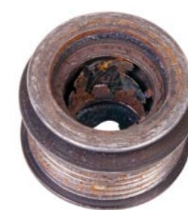
Z LEWEJ: PĘKNIĘCIE RAMIENIA NAPINAJĄCEGO Z POWODU NADMIERNYCH JEGO PRZEMIESZCZEŃ; Z PRAWYJ: USZKODZENIE JEDNOKIERUNKOWEGO MECHANIZMU BLOKUJĄCEGO (ALTERNATOR PRZESTAJE DZIAŁAĆ)
