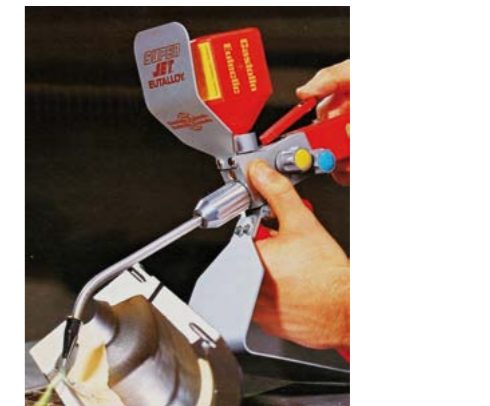
NAPAWANIE PŁOMIENIOWE – U GÓRY: FREZU, OBOK: FORMY ODLEWNICZEJ
