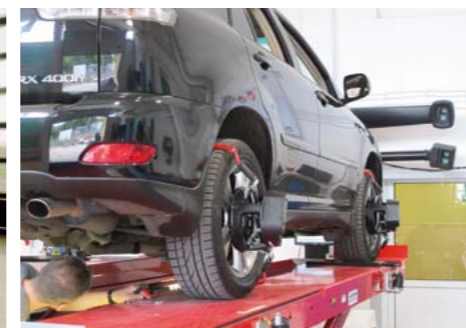
WYKORZYSTANIE DŹWIGNIKA NOŻYCOWEGO NA NOWOCZESNYM STANOWISKU KONTROLI GEOMETRII PODWOZI
