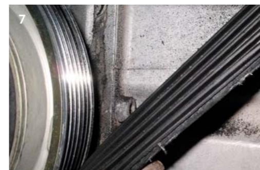
brak gumowego elementu tłumiącego; występuje wyłącznie O-ring po stronie zewnętrznej
