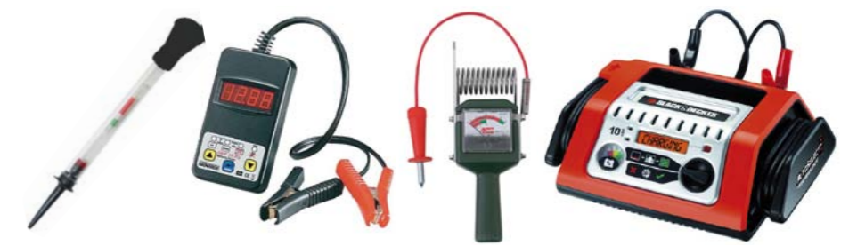
PODSTAWOWY SPRZĘT DO WARSZTATOWEJ OBSŁUGI AKUMULATORÓW. OD LEWEJ: AREOMETR, ELEKTRONICZNY TESTER NAPIĘCIA, WOLTOMIERZ Z OBCIĄŻENIEM OPOROWYM, ŁADOWARKA
