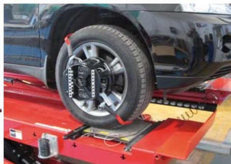
PRZEDNIE KOŁO DIAGNOZOWANEGO POJAZDU NA OBROTNICY
