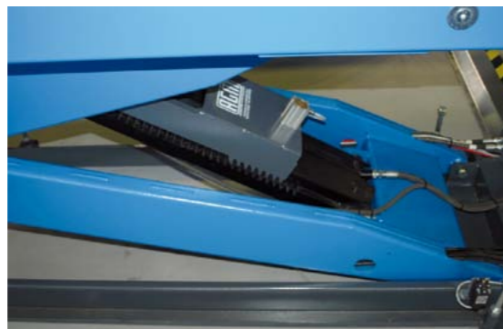
ZAPADNIA MECHANICZNA PODNOŚNIKA NOŻYCO- WEGO. ZWALNIANIE JEJ BLOKADY REALIZOWANE JEST PNEUMATYCZNIE
