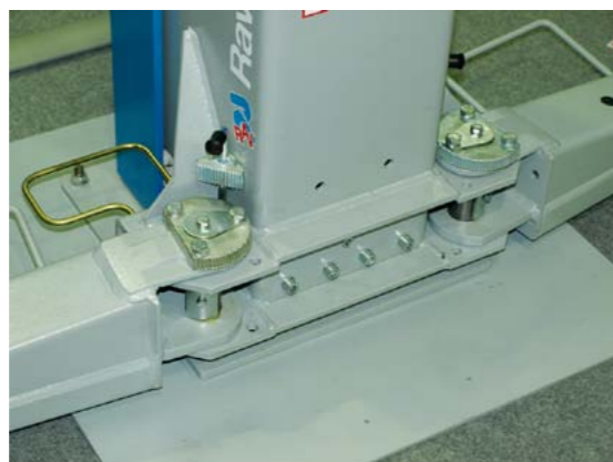
ELEMENTY AUTOMATYCZNEGO MECHANIZMU BLOKUJĄCEGO OBRÓT RAMION PODPOROWYCH
