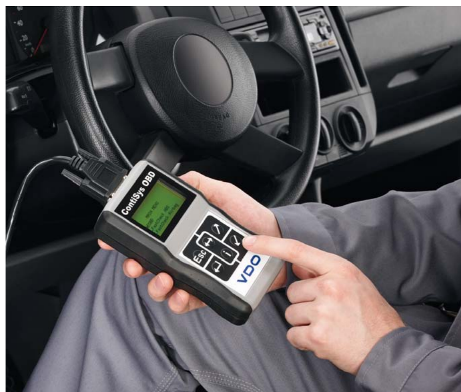
ELEKTRYCZNY HAMULEC POSTOJOWY ZE WZGLĘDU NA SWE ELEKTRONICZNE STEROWANIE MUSI BYĆ OBSŁUGIWANY ODPOWIEDNIM PRZYRZĄDEM DIAGNOSTYCZNYM
