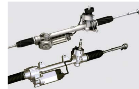
NASTĘPNĄ GENERACJĘ STANOWIĄ JUŻ URZĄDZENIA Z SILNIKAMI ELEKTRYCZNYMI ZAMIAST SIŁOWNIKÓW HYDRAULICZNYCH. NA ZDJĘCIU: SYSTEM ZF SERVOLETRIC
