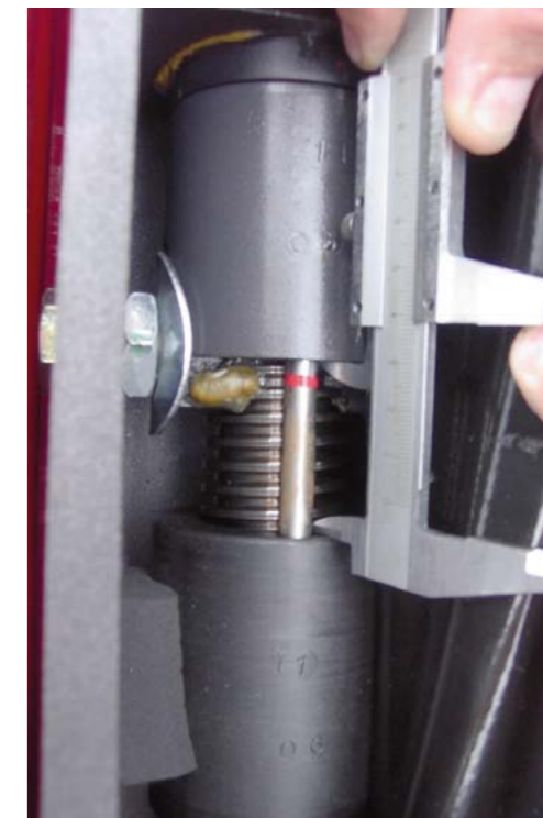
POMIAR ZUŻYCIA NAKRĘTEK W PODNOŚNIKU WERTHER 255. CZERWONA LINIA OZNAČA ZUŻYCIĘ GRANICZNE
