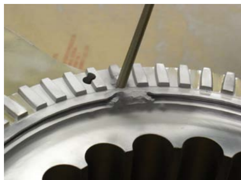
WYKRUSZONE KOŁO ZĘBATE W TRAKCIE REGENERACJI METODĄ CS
