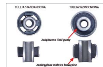
SPOSÓB WZMACNIANIA TULEI METALOWO-GUMOWEJ
