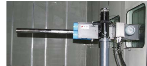
POWYŻEJ: URZĄDZENIE DO NATRYSKIWANIA DETONACYJNEGO; Z PRAWYJ: GŁOWICA DO NATRYSKIWANIA METODĄ HVOF
