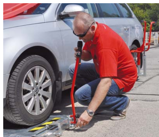
KONTROLA LUZÓW W ZAWIESZENIU ZA POMOCĄ UCHWYTU
