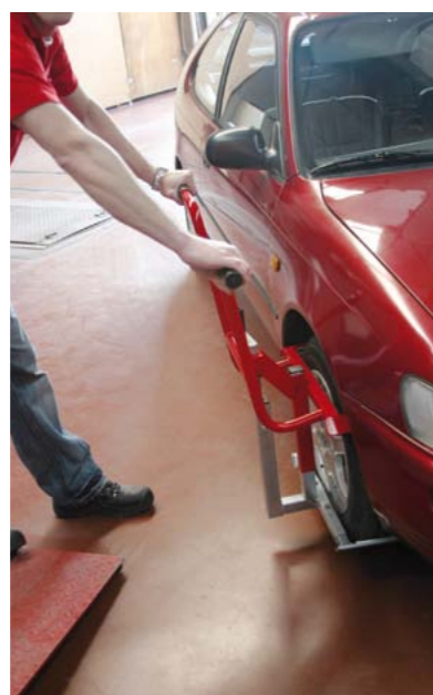
BADANIE STANU PRZEDNIEGO ZAWIESZENIA NA PŁYTCIE KONTROLNEJ
