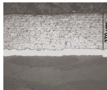
WARSTWA NATRYSKIWANA Z TLENKU CHROMU NA WARSTWIE POŚREDNIEJ Z NIKLU NANIESIONEJ NA PODŁOŻE Z TWORZYWA SZTUCZNEGO WZMOCNIONEGO WŁÓKNEM SZKLANYM
