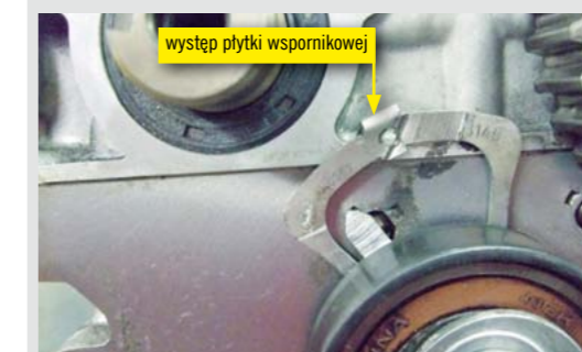
NAWET PRZY PRAWIDŁOWYM USYTUOWANIU PŁYTKI WSPORNIKOWEJ BŁĘDNE USTAWIENIE SAMEGO NAPINACZA MOŻE BYĆ POWODEM JEGO NIEWŁAŚCIWEGO ZAMOCOWANIA
