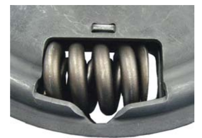
U GÓRY: TŁUMIK DRGAŃ SKRĘTNYCH O TŁUMIENIU WIELOSTOPNIOWYM. PONIŻEJ: SPOCZYNKOWE POŁOŻENIE KRÓTSZEJ SPRĘŻYNY W OKIENKU
