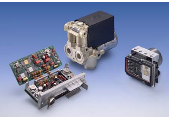
PORÓWNANIE ROZMIARÓW MODUŁÓW ABS BOSCHA. Z LEWEJ: D. GENERACJA (1978 R.) Z ODDZIELNYM PROCESOREM. Z PRAWY: ZINTEGROWANE URZĄDZENIE NAJNOWSZEJ GENERACJI
