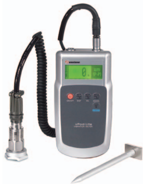
MIKROPROCESOROWY PRZYRZĄD EVA (ELECTRONIC VIBRATION ANALYZER) MIERZĄCY PRZYSPIESZENIA ORAZ AMPLITUDE I CZĘSTOTLIWOŚCI DRGAŃ
