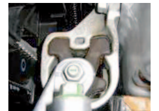
INSTALACJA DODATKOWEJ GUMOWEJ WKŁADKI W ELASTYCZNYM ZAWIESZENIU SILNIKA (SUBARU OUTBACK)
