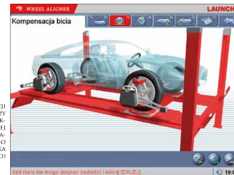
LASEROWY POMIAR ZBIEŻNOŚCI KÓŁ PRZEDNICH Z ZASTOSOWANIEM PRECYZYJNEJ OBROTNICY (ZDJĘCIE ŚRODKOWE) I UNIWEERSALNEGO UCHWYTU GŁOWICY (Z PRAWY) UMOŻLIWIĄCEGO KOMPENSOWANIE BICIA OBRĘCZY
