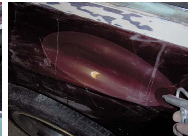
PRZY STOSUNKOWO GŁĘBOKICH NIERÓWNOŚCIACH PODŁOŻA KIT SZPACHLOWY NAKŁADA SIĘ KILKOMI WARSTWAMI (Z LEWEJ), A PRZY WKŁĘŚLOŚCIACH ROZLEGŁYCH, LECZ PŁYTKICH (Z PRAWYJ) CELOWE STAJE SIĘ UŻYCIĘ SZPACHLÓWKI NATRYSKOWEJ
