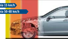
W KONSTRUKCJACH PRZEDNICH SEGMENTÓW SAMOCHODÓW OSOBOWYCH WYSTĘPUJĄ OBECNIE CO NAJMNIEJ DWIE STREFY O ZRÓŻNICOWANEJ PODATNOŚCI NA POWYPADKOWE ODKSZTAŁCENIA
