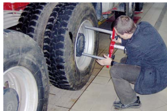
DAMIAN GUSTOWSKI Z FIRMY LEWOR DEMONSTRUJE MONTAŻ NOWOCZESNEJ GŁOWICY POMIAROWEJ DO TARCZY KOŁA
