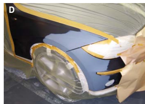
PO OSZLIFOWANIU USZKODZONEJ STREFY USTALA SIĘ METODY WYRÓWNIANIA POWIERZCHNI (A). GŁĘBSZE WKŁĘŚŁOŚCI RÓWNA SIĘ Z SĄSIEDNIĄ POWIERZCHNIĄ LAKIERU KITEM, A POTEM SZLIFUJE I LAKIERUJE CAŁĄ STREFĘ (B). PODOBNIJE POSTĘPUJE SIĘ W PRZYPADKU LICZNYCH NIERÓWNOŚCI PODŁOŻA (C). UBYTKI WYSTĘPUJĄCE TYLKO W POWŁOCE MOŻNA WYRÓWNAĆ SAMYM WYPEŁNIACZEM (D)
