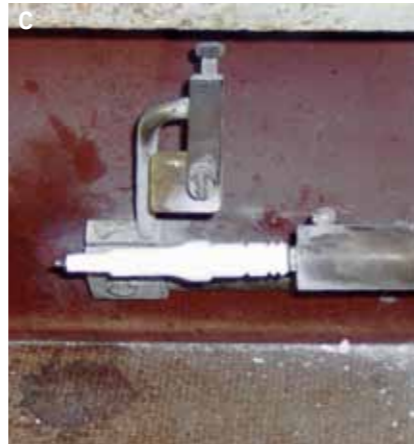
ŚWIECA „GAZOWA” RÓŻNI SIĘ OD „BENZYNOWEJ” MATERIAŁEM ELEKTROD (A), SKŁADEM WYPALANEJ MASY CERAMICZNEJ (B) ORAZ WYMIARAMI I KształETEM IZOLATORA (C)
