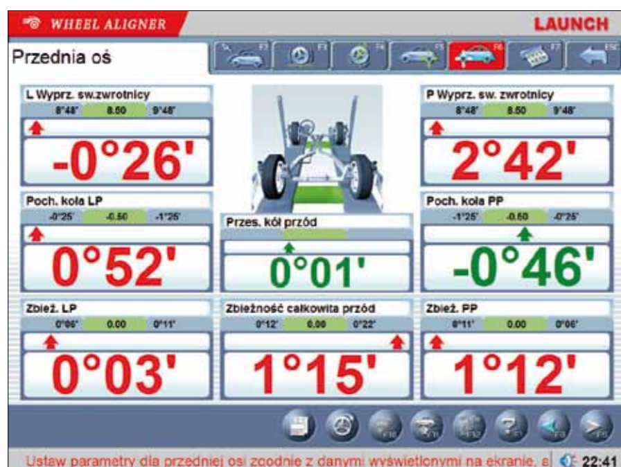
KOMPLEKSOWY, KOMPUTEROWY POMIAR PARAMETRÓW GEOMETRII KÓŁ I OSI
