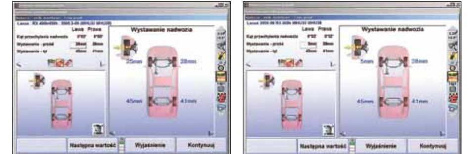
WYSTAWIANIE NADWOZIA POZA ZEWNĘTRZNĄ KRAWĘDZ KOŁA PRZED MODYFIKACJĄ (Z LEWEJ) ORAZ PO MODYFIKACJI
