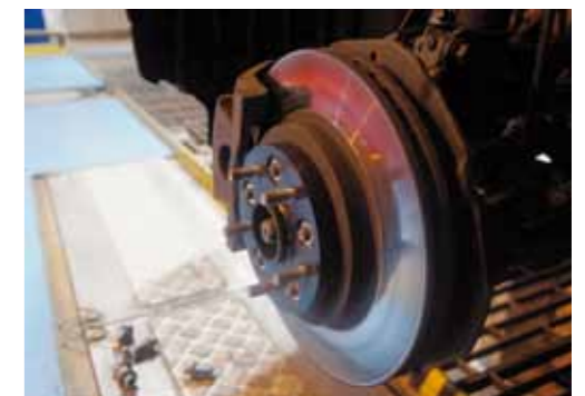
ZAMOCOWANIE TARCZY DYSTANSOWEJ O GRUBOŚCI 20 MM
