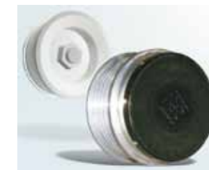
NAKRĘTKA KOŁA PASOWEGO ALTERNATORA JEST CHRONIONA DODATKOWĄ OSŁONĄ
