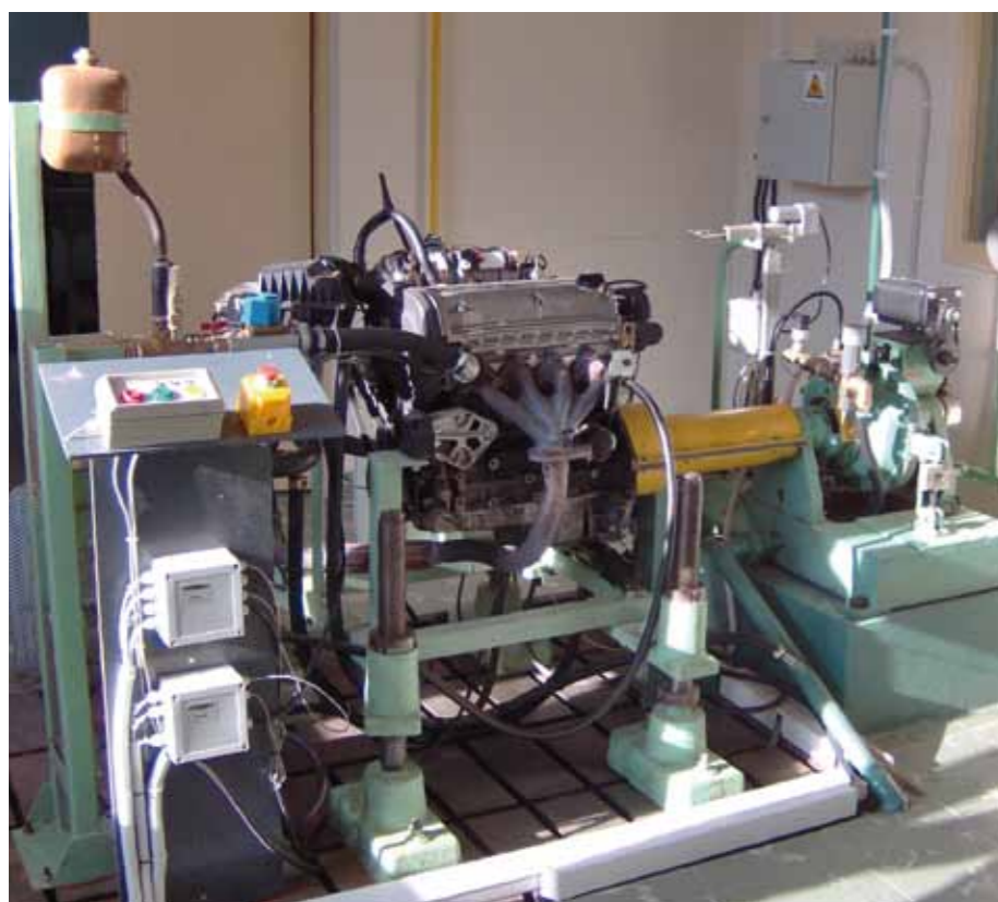
LABORATORIUM ISKRY: STANOWISKO DO BADAŃ ZAPŁONU W SERYJNYM SILNIKU SAMOCHODOWYM PRZY ZASILANIU BENZYNA I GAZEM CNG
