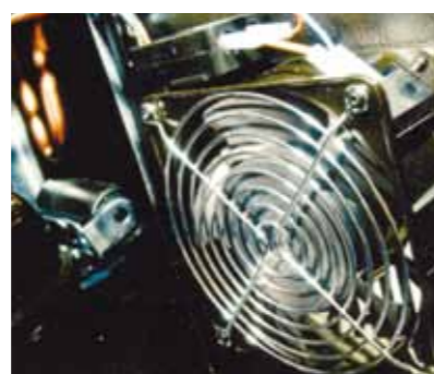
WENTYLATOR ZAPOBIEGAJĄCY GROMADZENIU SIĘ GAZU PALNEGO W OBUĐOWIE
