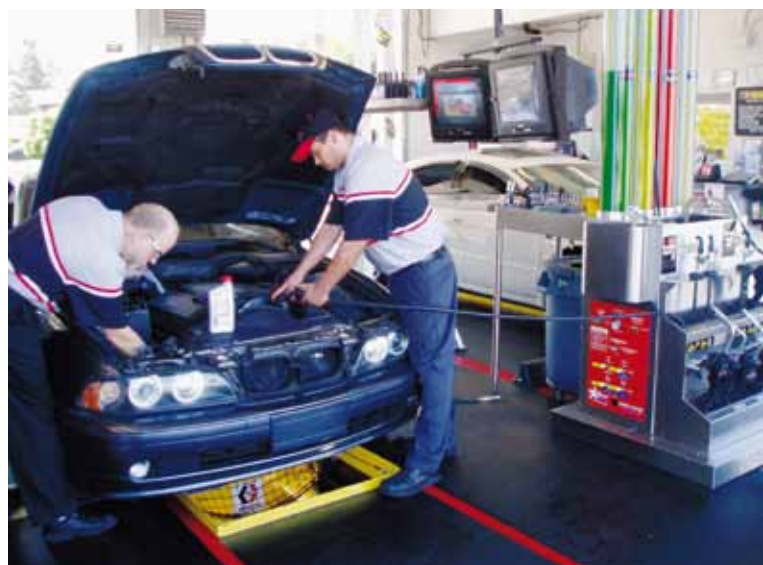
STANOWISKO DO NAPEŁNIANIA UKŁADÓW ŚWIEŻYM OLEJEM
