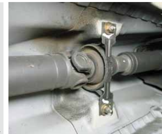
ŁOŻYSKO POŚREDNIE NA POŁĄCZENIU ODCINKÓW WAŁÓW. U GÓRY: WIDOK. Z LEWEJ: PRZEKRÓJ
