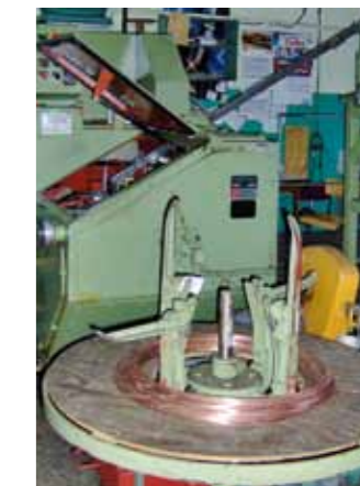
MASZYNOWE OSADZANIE MIEDZIANYCH RDZENI W STALOWYCH ELEKTRODACH
