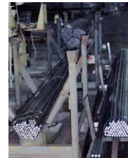
STALOWE PRĘTY: SUROWIEC DO AUTOMATYCZNEJ PRODUKCJI KORPUSÓW
