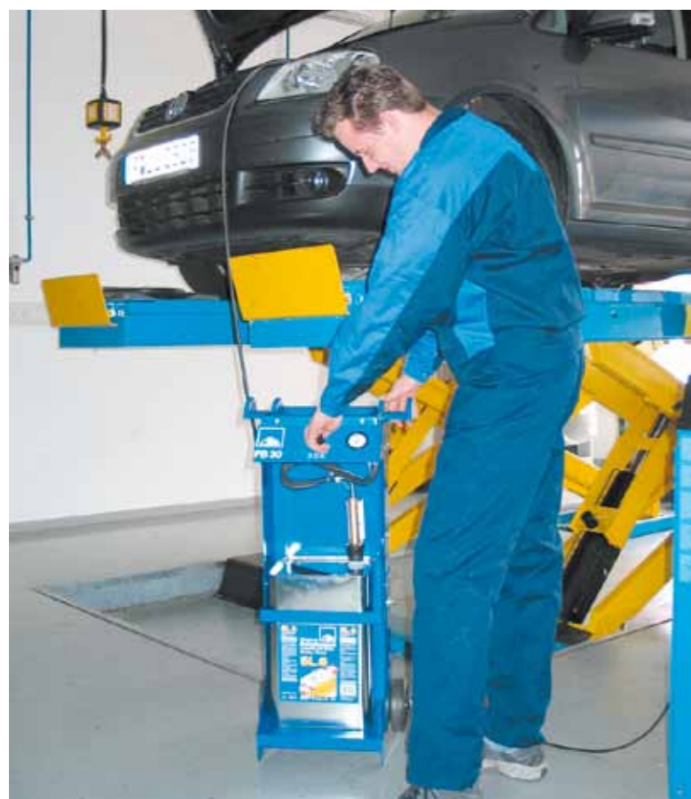
NOWOCZESNY SPRZĘT UMOŻLIWIA JEDNOSOBOWE ODPOWIETRZANIE HAMULCÓW
