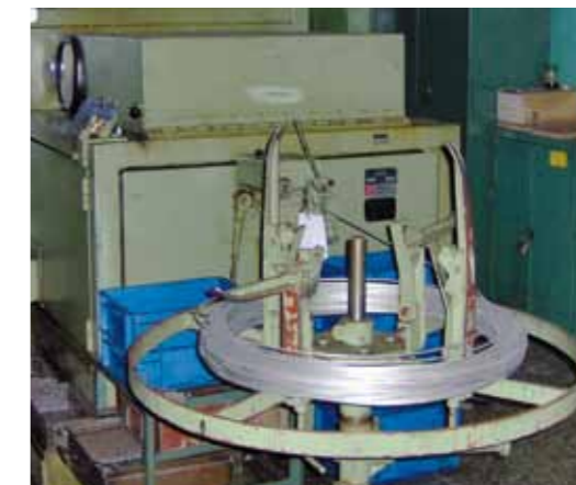
PRASA DO TŁOCZENIA ELEMENTÓW ELEKTRODY ŚRODKOWEJ Z DRUTU STALOWEGO
