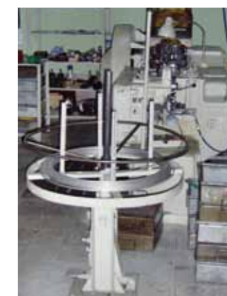
MASZYNOWE OSADZANIE MIEDZIANYCH RDZENI W STALOWYCH ELEKTRODACH
