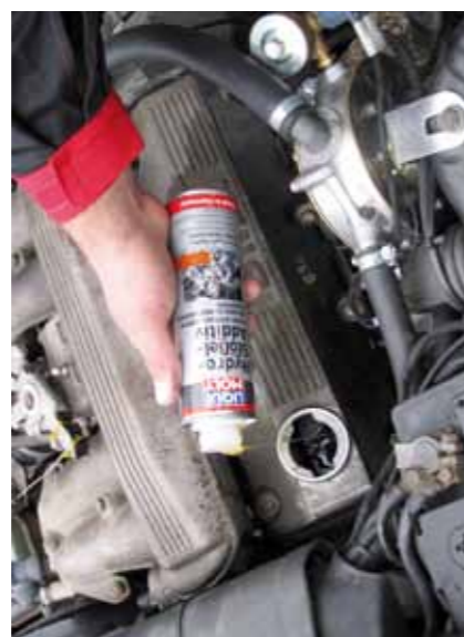
APLIKACJA PREPARATU REGENERUJĄCEGO HYDRAULICZNE POPYCHACZE ZAWORÓW
