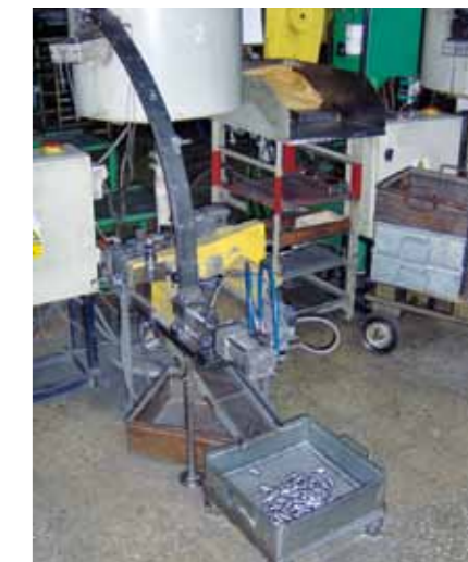
AUTOMAT WYKONUJE KOLEJNĄ FAZĘ OBRÓBKĘ – OBSŁUGA ZMIENNY POJEMNIKI
