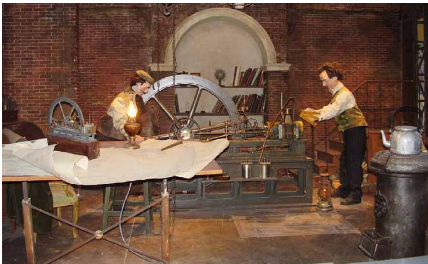
PIERWSZY SILNIK TŁOKOWY ZE SPALANIEM WEWNĘTRZNYM TO ZASILANA GAZEM KONSTRUKCJA ÉTIENNE'A LENOIRA Z 1860 ROKU
