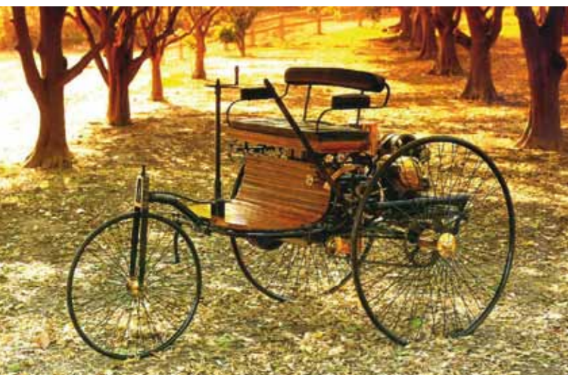
TRÓJKOŁOWIEC KARLA BENZA I JEGO LEKKI SILNIK CZTEROSUWOWY ZAINAUGUROWAŁY EPOKĘ MOTORYZACJI SPALINOWEJ
