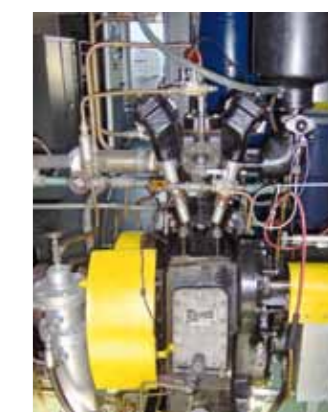
WZORCOWY SILNIK DO LABORATORYJNEGO TESTOWANIA ŚWIEC ZAPŁONOWYCH
