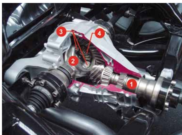
KLASYCZNY MECHANIZM RÓZNICOWY 1. WAŁ WEJŚCIOWY (ATAKUJĄCY) 2. KORPUS MECHANIZMU 3. SATELITY 4. KOŁO KORONOWE PÓŁOSI (JEDNO Z DWÓCH)
