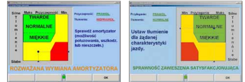
RYS. 4. WYNIKI TESTÓW TYLNEGO LEWEGO I TYLNEGO PRAWEGO ZAWIESZENIA W SAMOCHODZIE SUV
