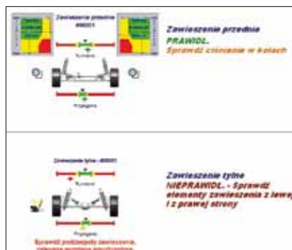
RYS. 3. OGÓLNE WYNIKI BADANIA ZAWIEŚZEŃ AUTA TYPU SUV
