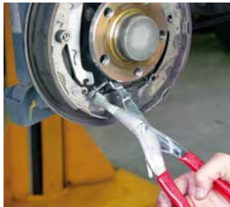
SPOSÓB MONTAŻU LUB DEMONTAŻU LINKI HAMULCA RĘCZNEGO SPECJALNYMI KLESZCZAMI
