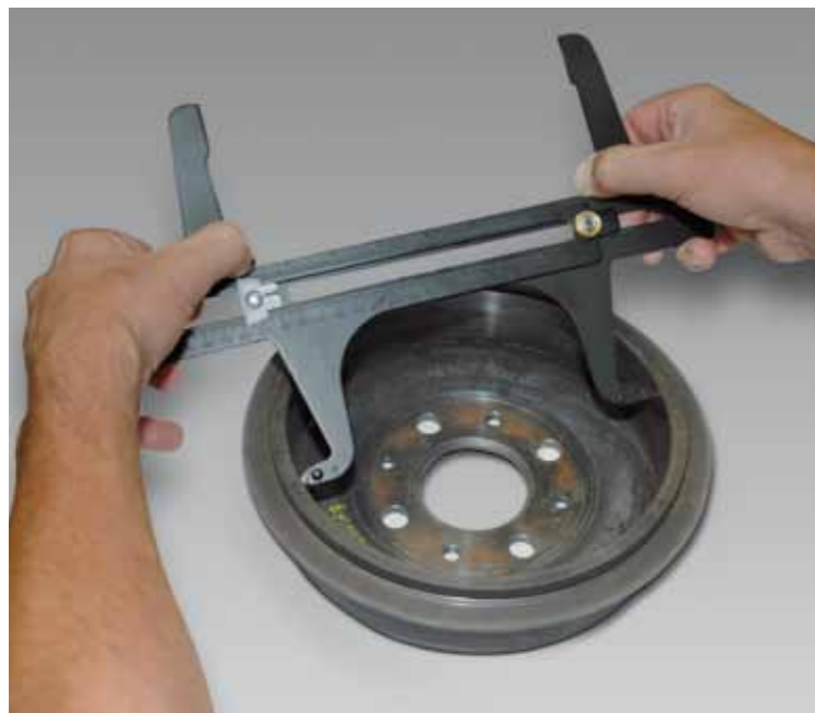
POMIAR ŚREDNICY BĘBNA HAMULCOWEGO. PO PRZETOCZENIU O PLUS 0,5 MM WZGLĘDEM ŚREDNICY NOMINALNEJ MOŻNA STOSOWAĆ TYLKO SZCZĘKI NADWYMIAROWE
