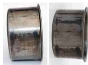
TERMICZNE PRZEBARWIENIA NA POWIERZCHNI KOŁA PASOWEGO NAPINACZA (Z LEWEJ) I ŚLADY STOPIONEJ GUMY NA KOLE PASOWYM
