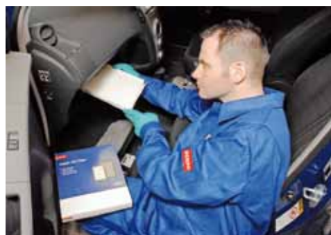
TYPOWE USYTUOWANIE FILTRA KABINOWEGO
