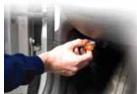
SPOSÓB INSTALACJI OBD LOG W POJEJDZIE
