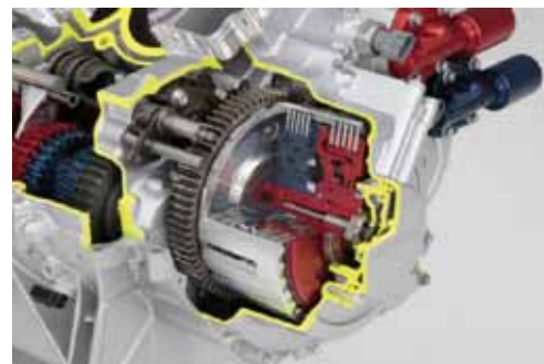
MOTOCYKLOWA SKRZYŃNIA DWUSPRZĘGŁOWA Z ELEKTRYCZNYMI SIŁOWNIKAMI STERUJĄCYMI (HONDA)
