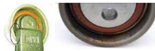
ZAKLESZCZENIE NAPINACZA NA SKUTEK BŁĘDNEJ JEGO REGULACJI (Z LEWEJ) I SKUTKI TEGO BŁĘDU
