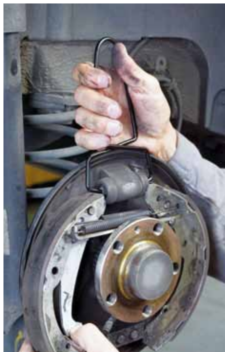
PRZY ZDEMONTOWANYCH SZCZĘKACH TŁOCZKI W CYLINDERKACH ROZPIERACZY MUSZĄ BYĆ ZABEZPIECZONE PRZED WYPADANIEM
