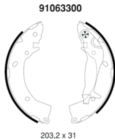
DLA JEDNOZNACZNEGO PRZY- PORZĄDKOWANIA SZCZĘK W KATA- LOGU Z RYSUNKAMI TMD PRZED- STAWIANY JEST ZAWSZE HAMULEC LEWY TYLNY
