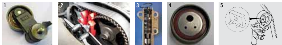
WZAJEMNE USTAWIENIE KOŁA I NAPINACZA PRZY PRAWIDŁOWEJ REGULACJI (1), ZABLOKOWANIE KÓŁ PASOWYCH WAŁÓW ROZRZĄDU (2), SPOSÓB ZABEZPIECZANIA NAPINACZA ZAWLECZKĄ MONTAŻOWĄ (3), PRAWIDŁOWE USTAWIENIE OTWORÓW KOŁA PASOWEGO (4) I UŻYCIĘ SPECJALNEJ NASADKI KLUCZOWEJ (5)
