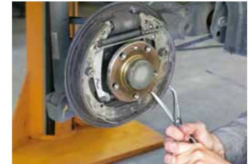
SPRĘŻYNY ODCIĄGAJĄCE SZCZĘK MONTUJE SIĘ I DEMONTUJE SPECJALNYM PRZYRZĘDEM
