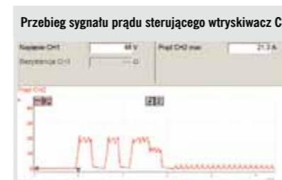
PRZEBIEGI OSCYLOSKOPOWE ZAREJESTROWANE PRZEZ DIAGNOSKOP FSA 740
