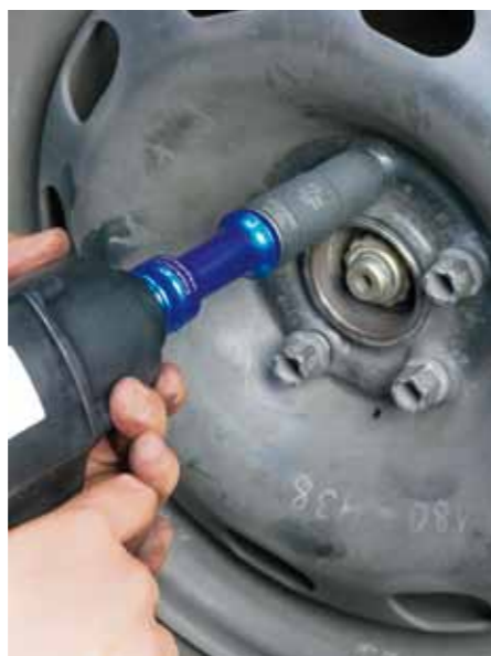
PRZY DOKRĘCANIU KÓŁ KLUCZEM PNEUMATYCZNYM OGRANICZNIK MOMENTU POWINIEN BYĆ TAK USTAWIONY, BY UMOŻLIWIĆ NASTĘPNIENIE PRECYZYJNE DOKRĘCENIE KLUCZEM DYNAMOMETRYCZNYM
