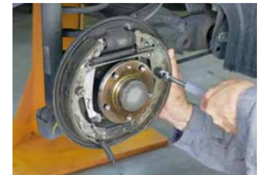
UŻYCIE SPECJALNEGO NARZĘDZIA DO OBSŁUGI POPRZECZNEGO MOCOWANIA SZCZĘK
