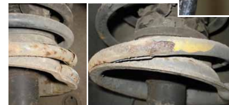
KOROZJA UJAWNIA SIĘ NAJPIERW POWIERZCHNIOWYM NALOTEM, POTEM POWSTAJĄ POGŁĘBIAJĄCE SIĘ WŻERY, A NA KOŃCU (U GÓRY) NASTĘPUJE ZMĘCZENIOWE PĘKNIĘCIE ZWOJU
