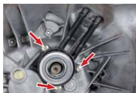
Montaż nowej części – moment dokręcania śrub 10 (+1) Nm
