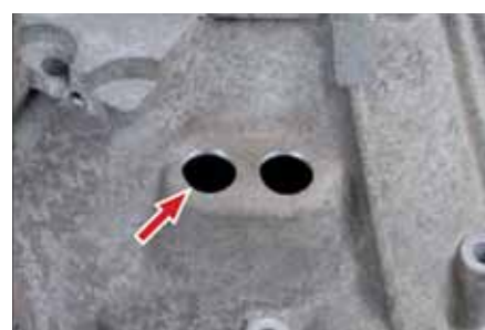
Stępianie krawędzi i czyszczenie wnętrza obudowy
