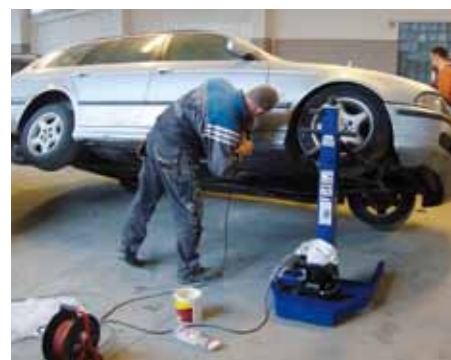
PODNOSZENIE ZA PRZEDNIE KOŁO POWODUJE SILNY PRZECHYŁ BOCZNY CAŁEGO POJAZDU
