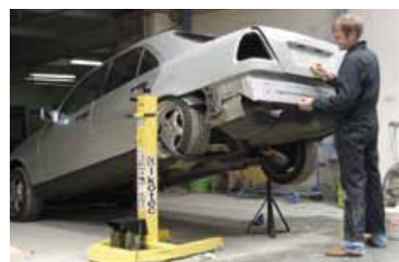
UCHWYT ZA TYLNE KOŁO ZAPEWNI SWOBODNY DOSTĘP DO WSZYSTKICH DOLNYCH ELEMENTÓW TYLNEJ CZĘŚCI NADWOZIA
