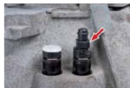
Odpowietrzanie siłownika hydraulicznego
