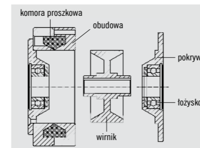
GLÓWNE CZĘŚCI SPRZĘGŁA PROSZKOWEGO
