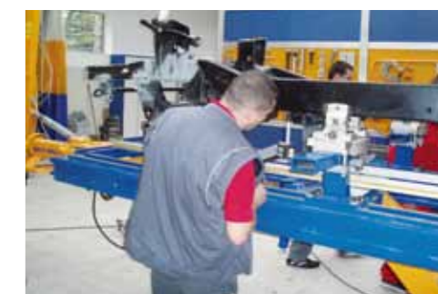
MOCOWANIE WYMONTOWANEJ RAMY NA STANOWISKU NAPRAWCZYM ZA POMOCĄ SPECJALNYCH UCHWYTÓW SZCZĘKOWYCH
