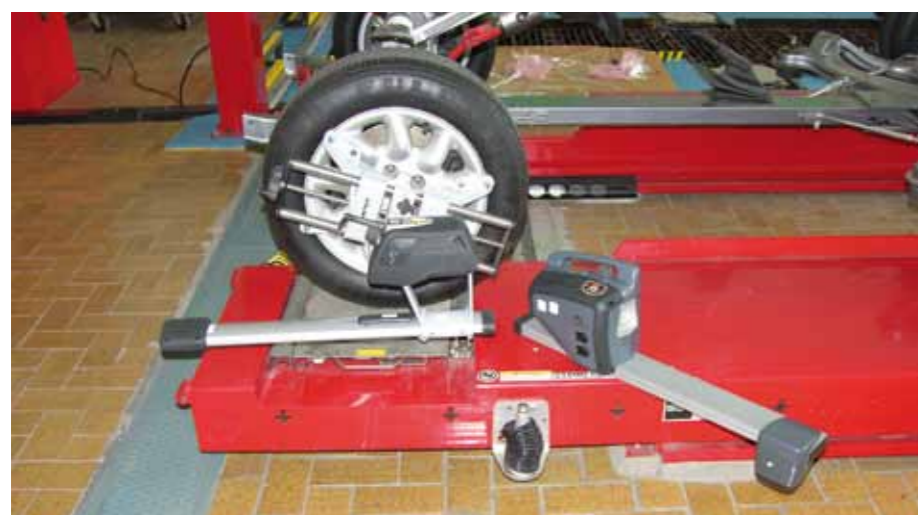
NOWY MODEL GŁOWICY DSP 700 (Z PRAWY) W PORÓWNIANIU Z GŁOWICĄ AKTYWNA DSP 500 PRODUKOWANĄ OBECNIE
