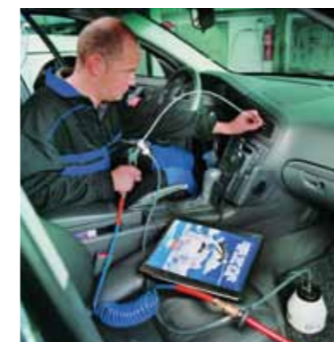
OD LEWEJ: APLIKOWANIE PREPARATU KLIMA-ANLAGEN-REINIGER ZA POMOCĄ RĘCZNEJ POMPKI; BIEŻĄCA DEZYNFEKCJA KANAŁÓW POWIETRZNYCH PREPARATEM KLIMA-FRESC; PRAWIDŁOWY ROZDZIAŁ NADMUCHU POWIETRZA W TRAKCIE DOKONYWANYCH ZABIEGÓW DEZYNFEKCYJNYCH
