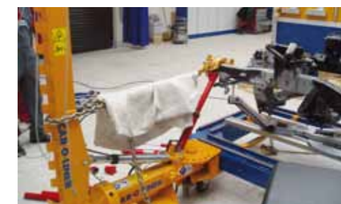
PROSTOWANIE SKRĘCENIA PRZEDNIEJ CZĘŚCI PODŁUŻNICY DOZEREM I WSPÓŁPRACUJĄCYM Z NIM HYDRAULICZNYM (CZERWONYM) ROZPIERACZEM
