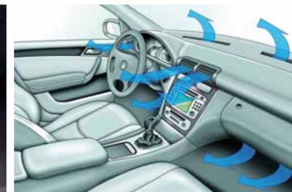
OD LEWEJ: APLIKOWANIE PREPARATU KLIMA-ANLAGEN-REINIGER ZA POMOCĄ RĘCZNEJ POMPKI; BIEŻĄCA DEZYNFEKCJA KANAŁÓW POWIETRZNYCH PREPARATEM KLIMA-FRESC; PRAWIDŁOWY ROZDZIAŁ NADMUCHU POWIETRZA W TRAKCIE DOKONYWANYCH ZABIEGÓW DEZYNFEKCYJNYCH
