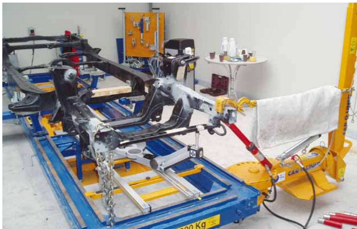
KOMPLETNE OPRZYRZĄDOWANIE DO PROSTOWANIA RAMY. ŁAŃCUCH PIONOWY ZABEZPIECZA RAMĘ PRZED WYRWIANIEM RAMY Z UCHWYTÓW, A GRUBY BIAŁY KOC ZAPOBIEGA SKUTKOM ZERWANIA ŁAŃCUCHA CIĄGNĄCEGO
