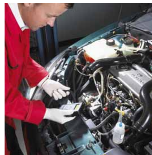
DO PEŁNEJ OBSŁUGI NOWOCZESNYCH WYSOKOCIŚNIENIOWYCH UKŁADÓW ZASILANIA POTRZEBNE SĄ NIE TYLKO SPECJALISTYCZNE NARZĘDZIA I SPRZĘT DIAGNOSTYCZNY, LECZ TAKŻE URZĄDZENIA I OPROGRAMOWANIE DO KODOWANIA WTRYSKIWACZY
