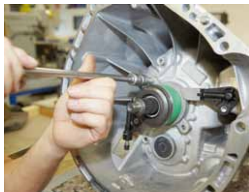
FOT. 8. INSTALACJA NOWEGO WYSPRZĘGLIKA CDC
