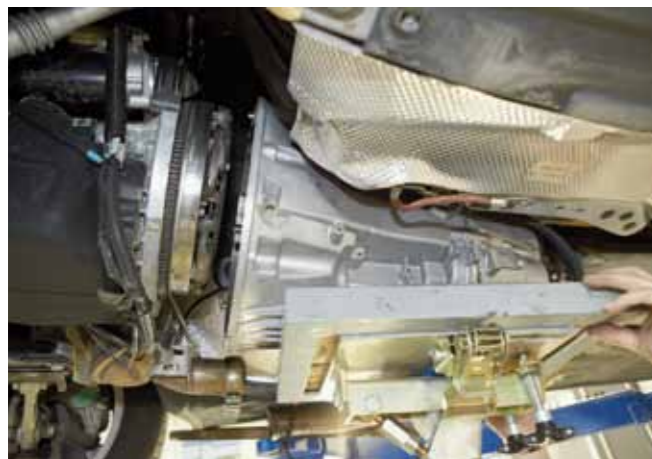
FOT. 3. DEMONTAŻ SKRZYNI BIEGÓW
