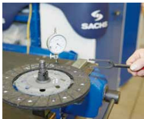
FOT. 5. KONTROLA BICIA POPRZECZNEGO TARCZY
