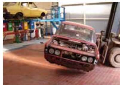
PO MECHANICZNYM DEMONTAŻU ZOSTAJE TYLKO SAMO NADWOZIE...
