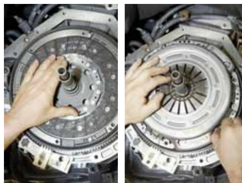
FOT. 7. INSTALACJA NOWEJ TARCZY ORAZ POKRYWY SPRZĘGŁA
