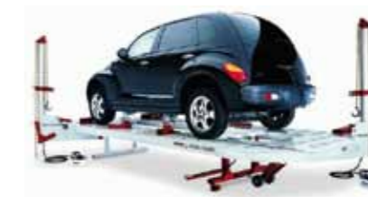
PROFESJONALNA RAMA I ELEKTRONICZNY SYSTEM POMIAROWY CHIEF
