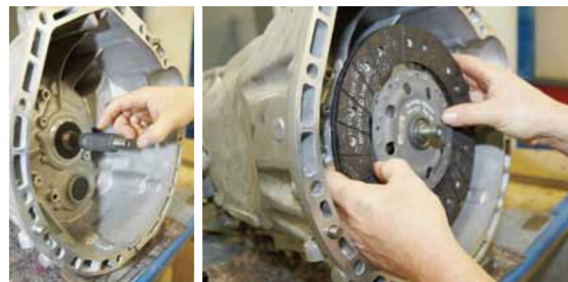
FOT. 6. SMAROWANIE WIELOKLINU WAŁU WEJŚCIOWEGO
