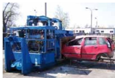
... KTÓRE TRZEBA ROZDROBNIĆ W MASZYNIE ZWANEJ SPTRZĘPIARKĄ
