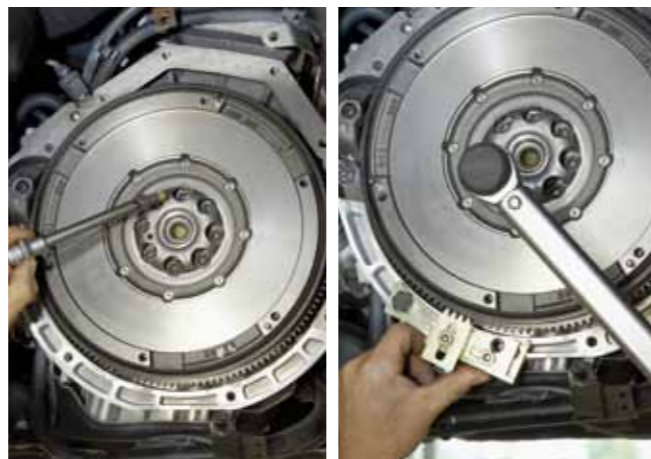
FOT. 4. MONTAŻ NOWEGO KOŁA DMF
