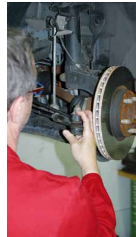
SPRAWDZANIE LUZU OSIOWEGO SWORZNIA
