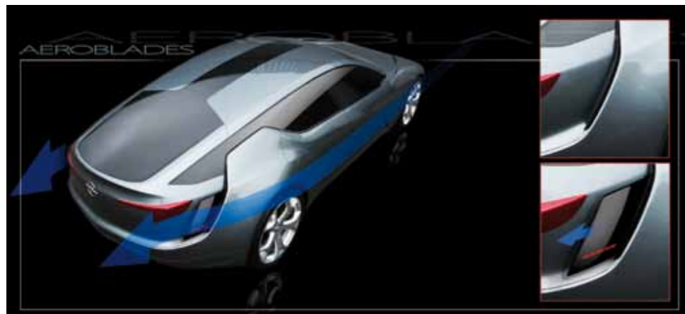
OPEL FLEXTREMA I JEGO AKTYWNA AERODYNAMIKA
