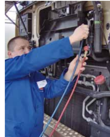
OBŚLUGĘ DUŻYCH KLIMATYZATORÓW UŁATWIAJĄ DŁUGIE PRZEWOŁY I ZNAZNA POJEMNOŚĆ BUTLI
