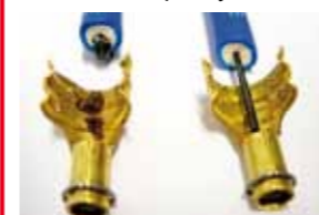
Tańsze (z lewej) i droższe (z prawej) końcówki przewodów węglowych
