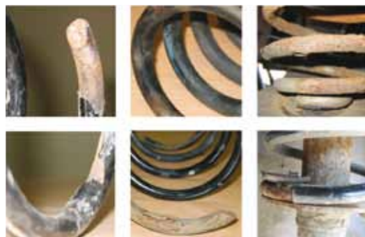
KOROZYJNE WZERY NA POWIERZCHNI SPRĘŻYN SZYBKO POGŁĘBIAJĄ SIĘ, DOPROWADZAJĄC DO PĘKNIĘĆ
