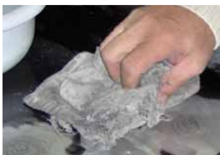
SCHŁADZANIE PODGRZANEGO MIEJSCA SZMATĄ MOCZONĄ W WODZIE
