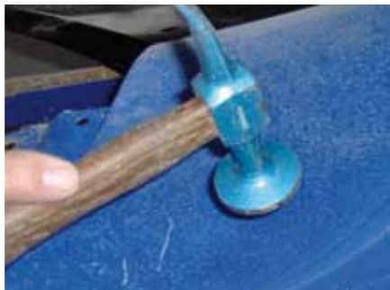
PIERWSZA FAZA PROSTOWANIA WGNIECENIA PO ZACIEŚNIANIU SPIRALI
