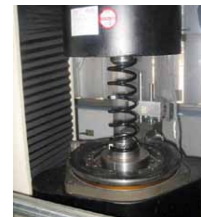
U GÓRY: SPRĘŻYNY „MINIBLOCK”. U DOŁU: PRÓBA ZMĘCZENIOWA SPRĘŻYNY STANDARDOWEJ W LABORATORIUM WYTRZYMAŁOŚCIOWYM
