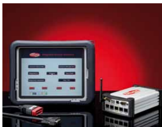
Z LEWEJ: ZESTAW URZĄDZEŃ DIAGNOSTYCZNYCH NA BAZIE KOMPUTERÓW TYPU TABLET PC, Z PRAWYJ: TESTER PDA STEROWANY Z KIESZONKOWEGO KOMPUTERA PC
