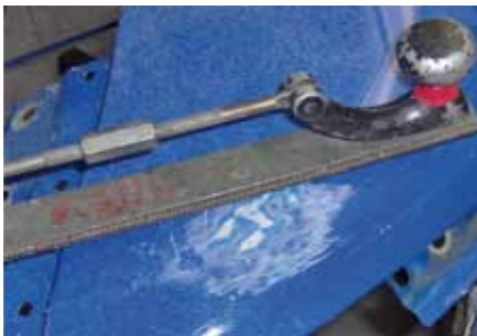
KONTROLA NAPRAWIONEJ STREFY PILNIKIEM BLACHARSKIM
