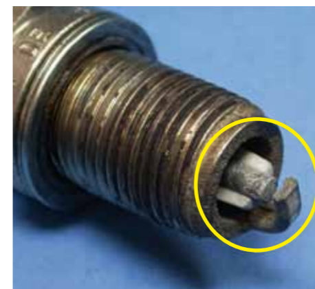
WEWNĘTRZNA KOŃCÓWKA IZOLATORA USZKODZONA NA SKUTEK PRZEGRZANIA I WIBRACJI
