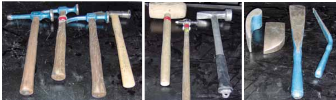
OD LEWEJ: MŁOTKI DO OBRÓBKI BLACH STALOWYCH (OSTATNI TYPU „KARO”), MŁOTKI DO ALUMINIUM (DREWNIANY, NIERDZEWNY, ALUMINIOWY), KLEPADEŁA („COMA”, STANDARDOWE Z RĘKOJĘCİĄ PROSTĄ I WYGIĘTĄ)
