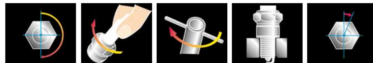
KOLEJNE (OD LEWEJ) FAZY WYMIANY ŚWIECY: ODKRĘCENIE KLUCZEM CZĘŚCI ZUŻYTEJ, RĘCZNE WKRĘCENIE NOWEJ, DOKRĘCENIE KLUCZEM RURKOWYM DO OPORU, A POTEM DYNAMOMETRYCZNYM DO ZADANEJ WARTOŚCI MOMENTU
