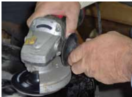
SZLIFOWANIE POWIERZCHNI BLACHY PRZED OBKURCZANIEM TERMICZNYM
