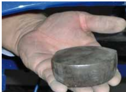
KLEPADŁO PRZYKŁADANE OD SPODU NA ŚRODKU ZAGŁĘBIENIA
