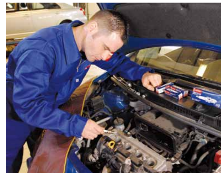
W PIERWSZEJ FAZIE MONTAŻU NOWĄ ŚWIECĘ NALEŻY DOKRĘCIĆ DO OPORU PALCAMI
