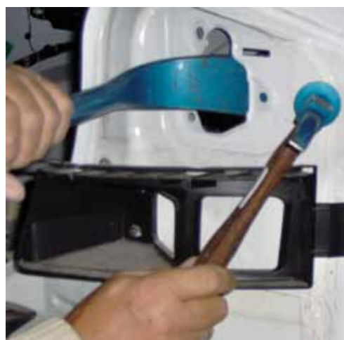
SPOSÓB UŻYCIA KLEPADEŁA ŁYŻKOWEGO Z RĘKOJĘCİĄ WYGIĘTĄ (NA DOLNYM ZDJĘCIU WIDOK OD WNĘTRZA NADWOZIA)
