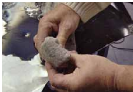
KLEPADŁO OWINIĘTE TKANINĄ PRZY PROSTOWANIU BLACHY ALUMINIOWEJ
