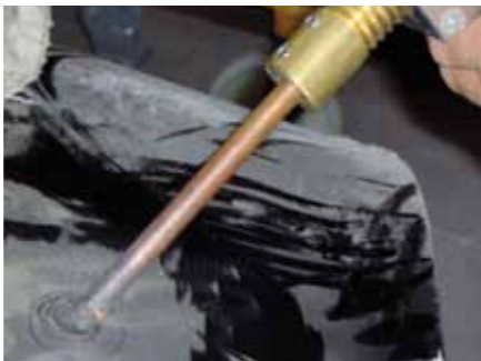
MIEJSCOWE NAGRZEWANIE ROZCIĄGNIĘTEGO MATERIAŁU ELEKTRODĄ WĘGLOWĄ
