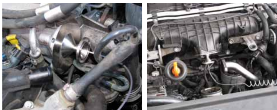
DYFUZOR Z APLIKATOREM DOCISKANY JEST DO KOLEKTORA SSĄCEGO WYŁĄCZNIE CIŚNIENIEM ATMOSFERYCZNYM
