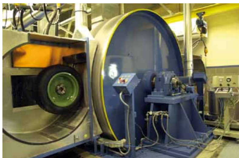
BADANIE DYNAMICZNE STANU OPONY PRZEZNACZONEJ DO BIEŻNIKOWANIA
