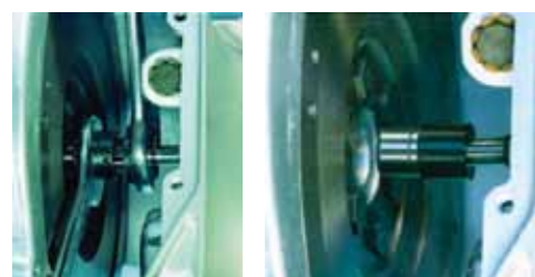
DEMONTAŻ ŁOŻYSKA ŚCIĄGACZEM Z ROZPRĘŻNĄ KOŃCÓWKĄ ORAZ MONTAŻ ŁOŻYSKA ZA POMOCĄ TULEI PROWADZĄCEJ O ODPOWIEDNICH WYMIARACH
