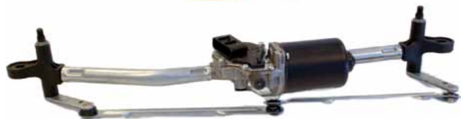
NAPĘD ELEKTRYCZNY PRZEDNIH WYCIERACZEK
