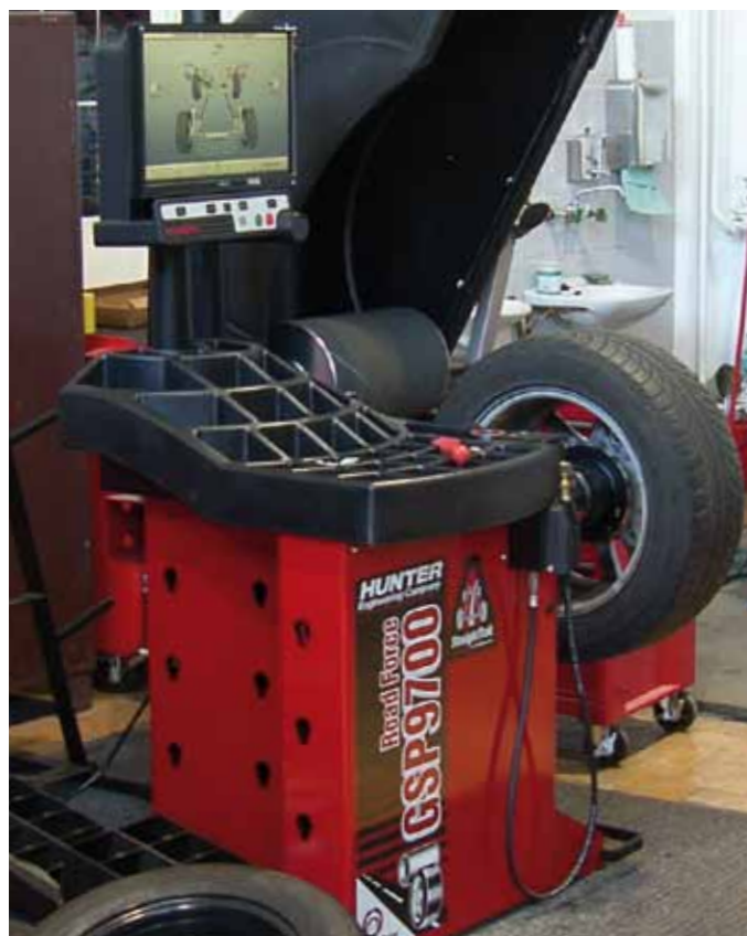
WYWAŻARKA HUNTER OBSŁUGUJĄCA SYSTEM TPMS
