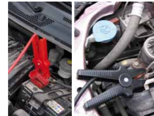
PRAWIDŁOWE PODŁĄCZENIE ZEWNĘTRZNEGO ŹRÓDŁA PRĄDU
