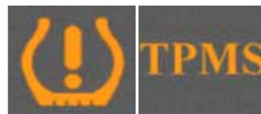
IKONY NA TABLICY ROZDZIELCZEJ INFORMUJĄCE, ŻE POJAZD JEST WYPOSAŻONY W SYSTEM TPMS
