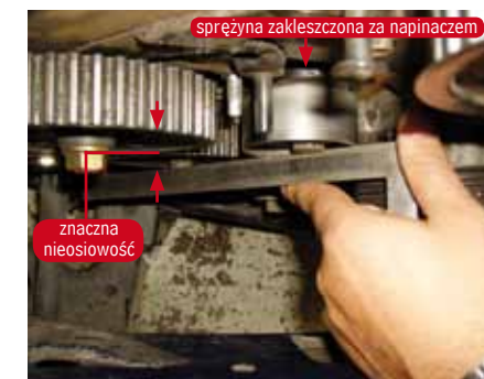
Rys. 6. Skutek błędnego zamontowania sprężyny
