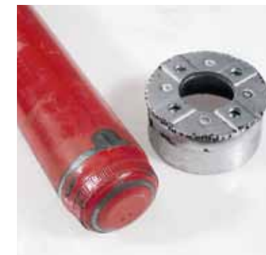
Spowodowane tarciem ubytki na wkładzie kolumny McPhersona
