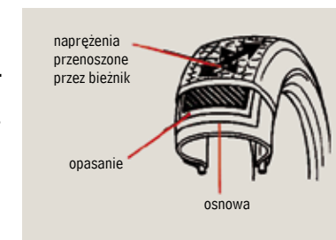
Efekt karbu – skutek warstwowej budowy opony
