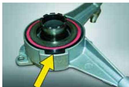
Łożysko oporowe prawidłowo osadzone w siłowniku CSC
