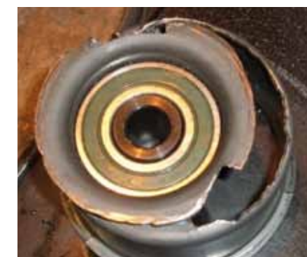
Rys. 8. Całkowicie zniszczona rolka prowadząca
