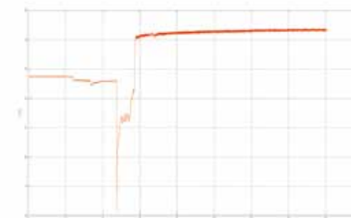
Rys. 3. Przebieg napięcia akumulatora podczas rozruchu silnika
