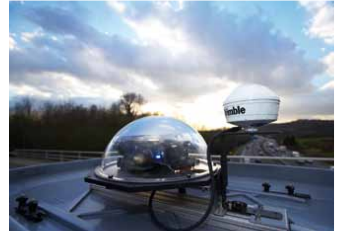
Zainstalowane na dachu obrotowe kamery wideo
