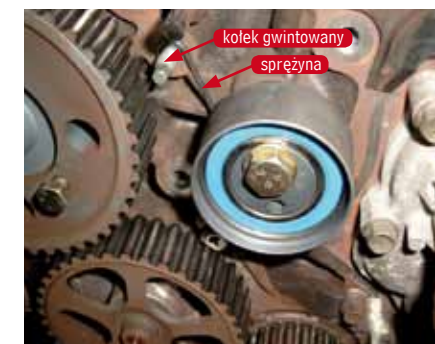
Rys. 5. Miejsce osadzenia dodatkowego kołka
