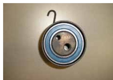
Rys. 2. Napinacz nowy Nr OE 5636739
