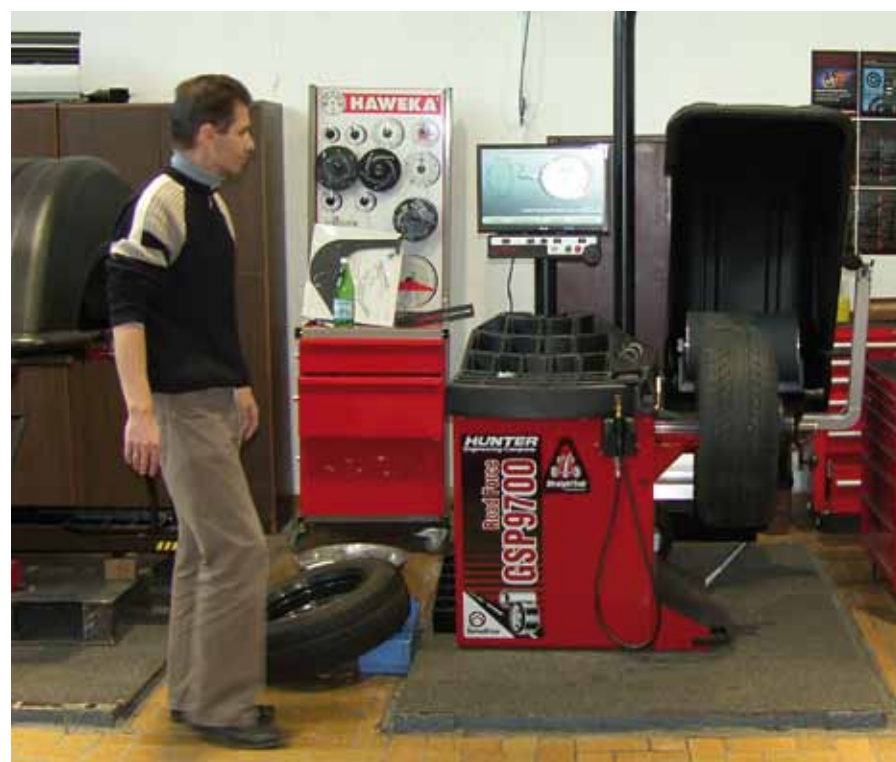
Wyważarka High-end z rolką dociskową do symulowania drogowych testów opon
