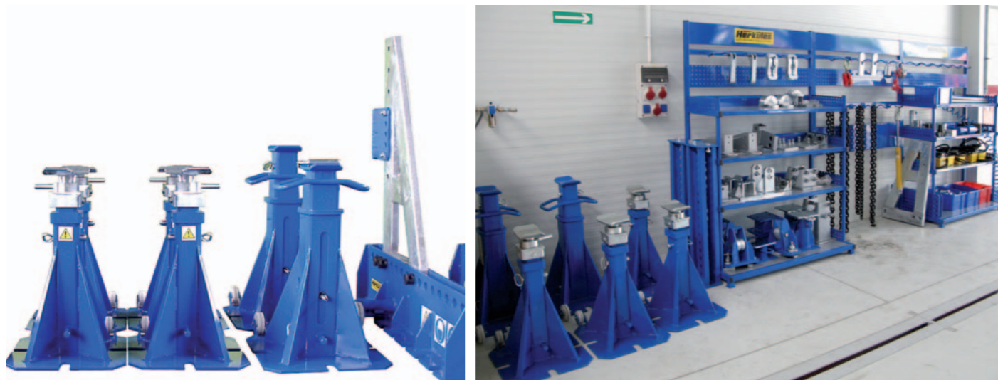
Osprzęt firmy Herkules SC do współpracy z prowadnicami zakotwionymi w podłodze warsztatu
