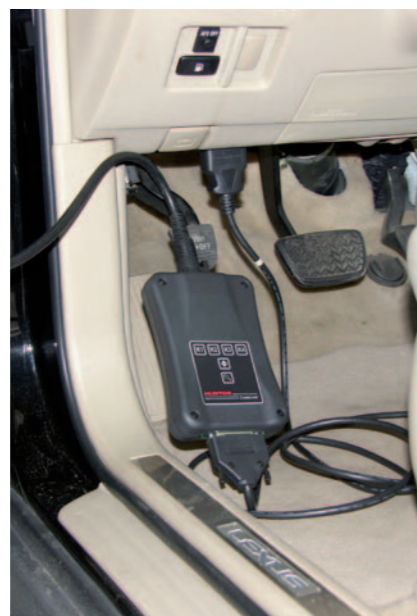
Moduł CodeLink™ podłącza się do gniazda diagnostycznego samochodu na stanowisku do kontroli geometrii podwozia
