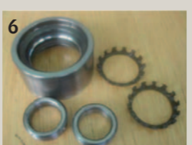
6 Całkowite zniszczenie łożyska przy zbyt małym momencie dokręcenia śruby lub jej zluźnieniu
