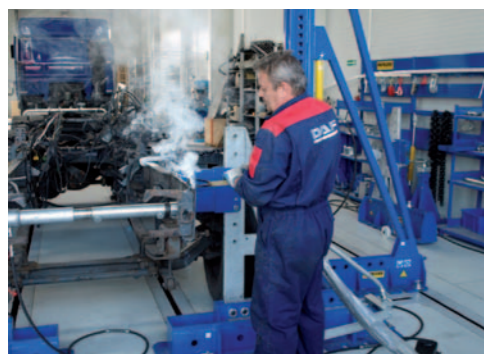
Zastosowanie profesjonalnego podgrzewacza indukcyjnego szwedzkiej firmy Alesco
