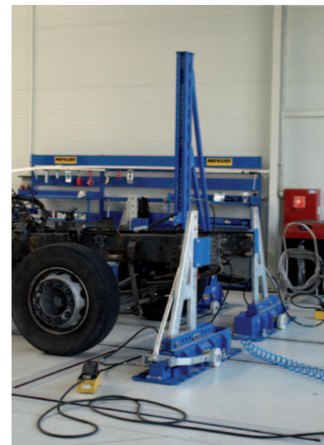
Przykłady prostowania uszkodzonych ram nośnych samochodów ciężarowych
