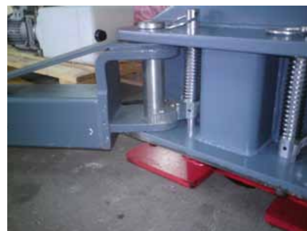
Z lewej: zapadka bezpieczeństwa współpracująca z grzebieniem zębatym wózka unoszącego pojazd, z prawej: mechanizm blokujący ustawienie pozycji roboczej ramion podnośnika
