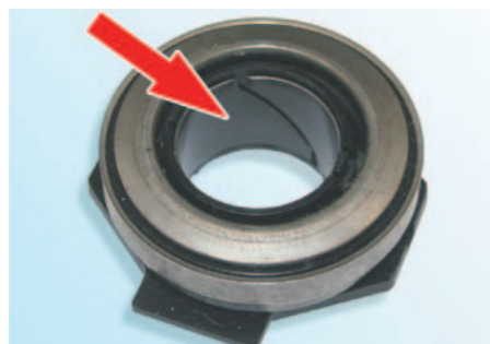
Tuleja ślizgowa Permaglide zapewniająca niski współczynnik tarcia bez smarowania
