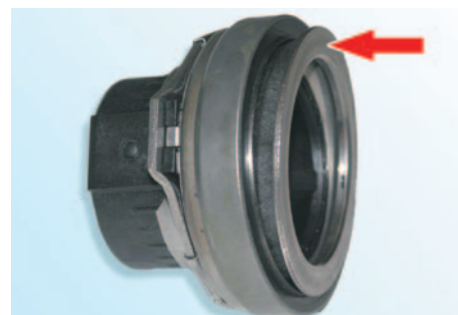
Dodatkowy mechanizm wyrównujący stosowany w osobowych modelach BMW
