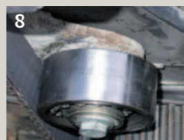
8 Uszkodzenie uszczelnienia podczas montażu i zniszczenie koszyka prowadzącego kulki
