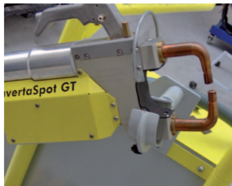
Miniaturyzacja elementów pozwala pomieścić w kleszczach transformator, inwertor, pneumatyczny mechanizm docisku i wodny obieg chłodzenia
