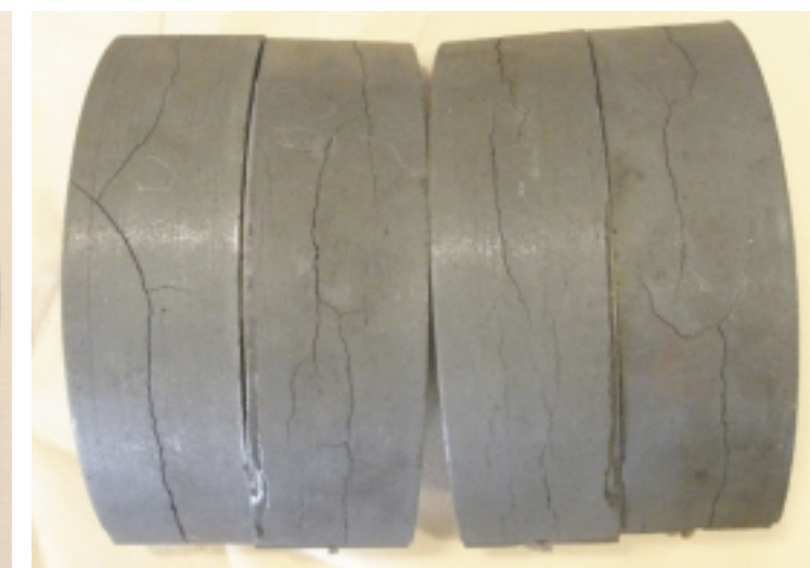
Zanieczyszczenie okładzin olejem lub płynem hamulcowym doprowadza z czasem do ich pęknięcia
