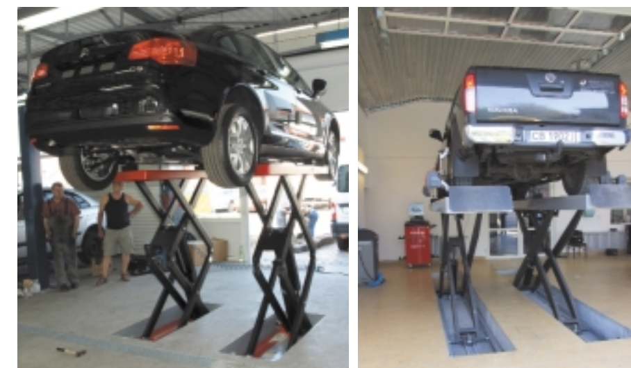
Podnośniki nożycowe: podprogowy (z lewej) ma takie same funkcje, jak dwukolumnowy, a najazdowy może zastępować czterokolumnowy
