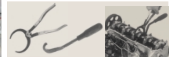
Oprzyrządowanie do obsługi płytkowej regulacji luzów zaworowych
