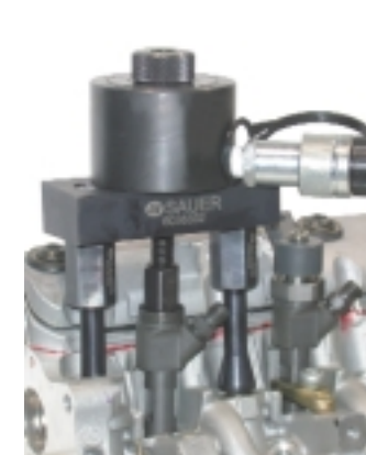
Przyrząd do demontażu wtryskiwaczy
