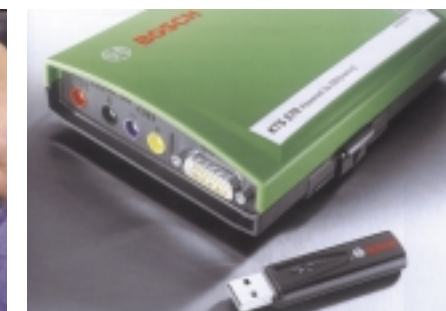
Diagnoskop – przystawka do PC z komunikacją bezprzewodową
