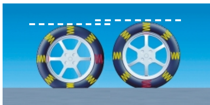
Spłaszczenie opony obciążonej zmniejsza rzeczywisty promień koła
