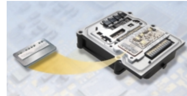
Czujnik przyspieszeń zintegrowany ze sterownikiem ESP
