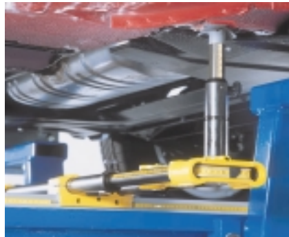
Mechaniczny system do pomiarów płyty podłogowej
