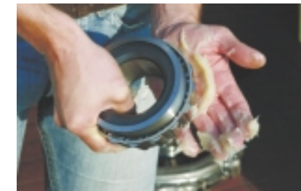
Najprostsz i najskuteczniejszy sposób smarowania łożysk stożkowych
