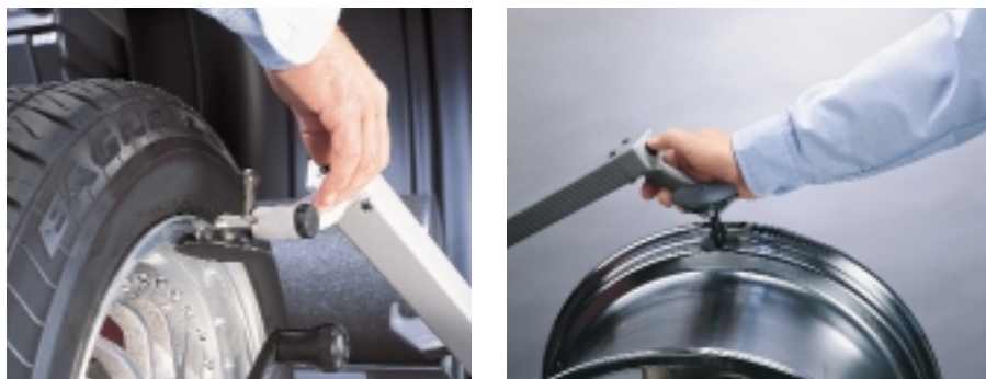
Kontrola osiowej i promieniowej niejednorodności kształtu obręczy
