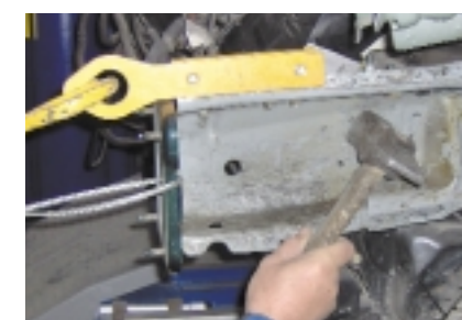
Prostowany element należy klepać młotkiem dla usunięcia naprężeń wewnętrznych blachy, a na koniec zablokować nastawnymi podpórkami
