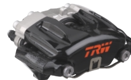
Lepsza konstrukcja zacisku pozwala zwiększyć średnicę tarczy, czyli siłę hamowania koła
