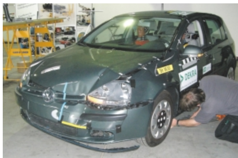
Każde, nieznaczne nawet odkształcenie zewnętrzne oznacza konieczność wykonania pomiarów całego nadwozia
