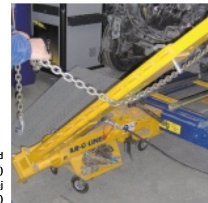
Prostowanie podłużnicy rozpoczynamy od zamocowania odpowiedniego zaczepu (u góry) i wstępnego ustawienia kierunku przykładanej siły (z prawej)
