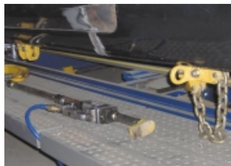
Mocowanie zacisków po obu stronach wgniecenia
