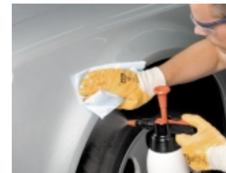
Mycie strefy uszkodzonej
