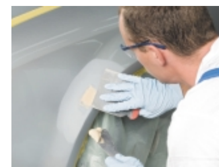
Nakładanie kitu szpachlowego
