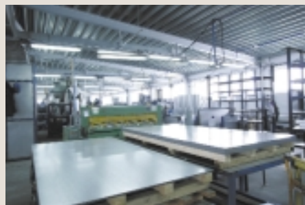
Stanowisko rozkroju blach na puszki tłumików
