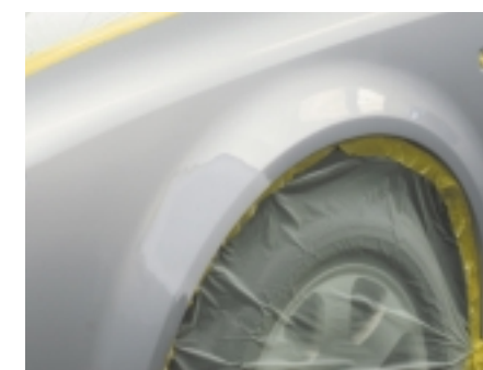
Podłożo gotowe do nałożenia nowej powłoki
