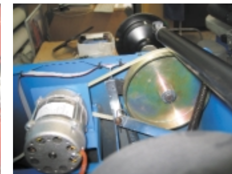
Mechanizm napędu wrzeciona wyważarki. W podporach (zjęcie z prawej) umieszczone są czujniki sił mierzone w dwu płaszczyznach
