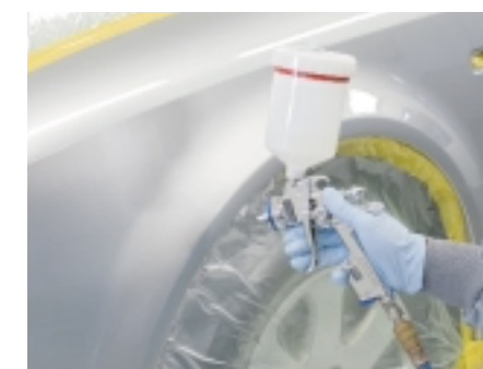
Nanoszenie lakieru bazowego i nawierzchniowego
