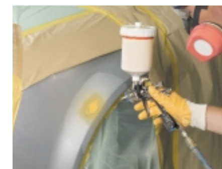
Gruntowanie odsłoniętych powierzchni metalu
