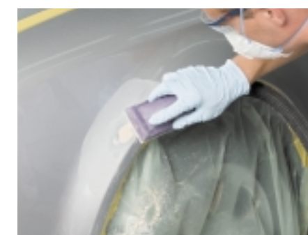
Ręczne szlifowanie szpachłówki lub wypełniacza
