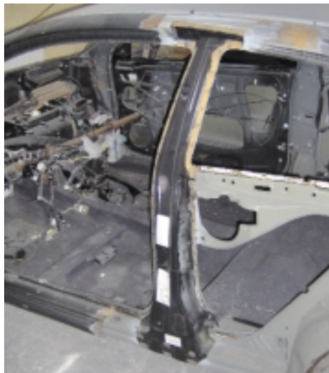
Uszkodzony słupek ze stali ultrawytrzymałej, przygotowany do całkowitej wymiany. Strażacy ratujący ofiary wypadków z tego rodzaju nadwozi muszą dysponować nożycami o specjalnie wzmocnionej konstrukcji
