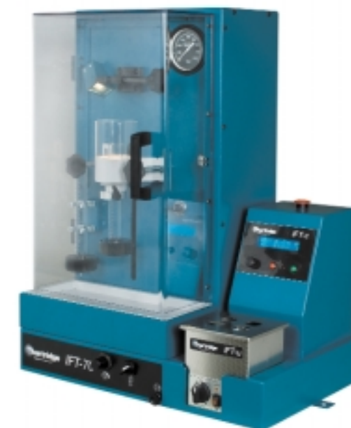
IFT-70 – nowy, uniwersalny tester wtryskiwaczy i pomp systemów common rail
