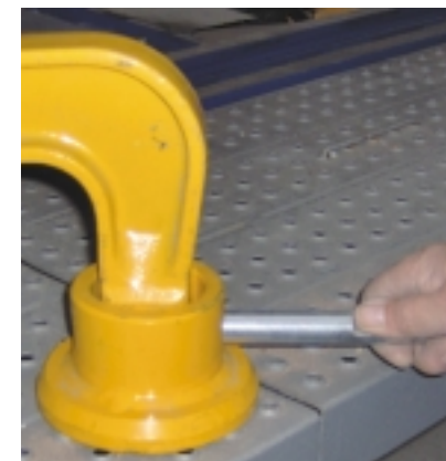
Wieloczęściowy zacpek do prostowania gniazd kolumn McPhersona. Najpierw łączy się tarcze oporowe z obu stron otworu, potem montuje hak, a do haka łańcuch ciągnący
