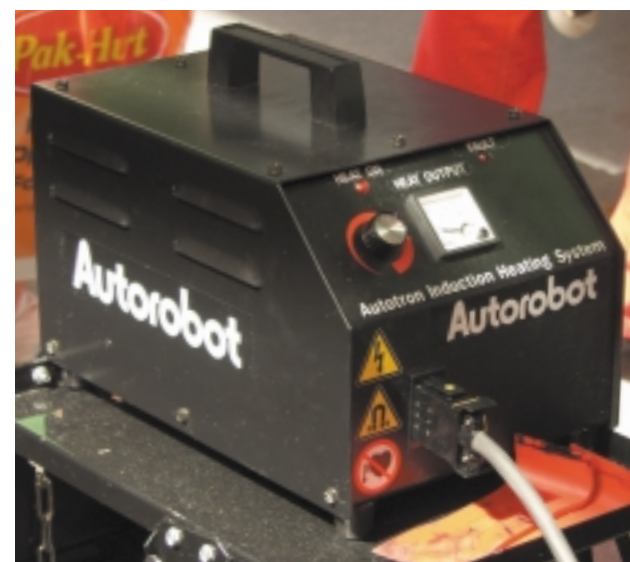
Części systemu AAT 33. Po lewej: generator o regulowanej mocy, z prawej: zestaw wymiennych elektromagnesów i (na pierwszym planie) kliny do podważania szyb
