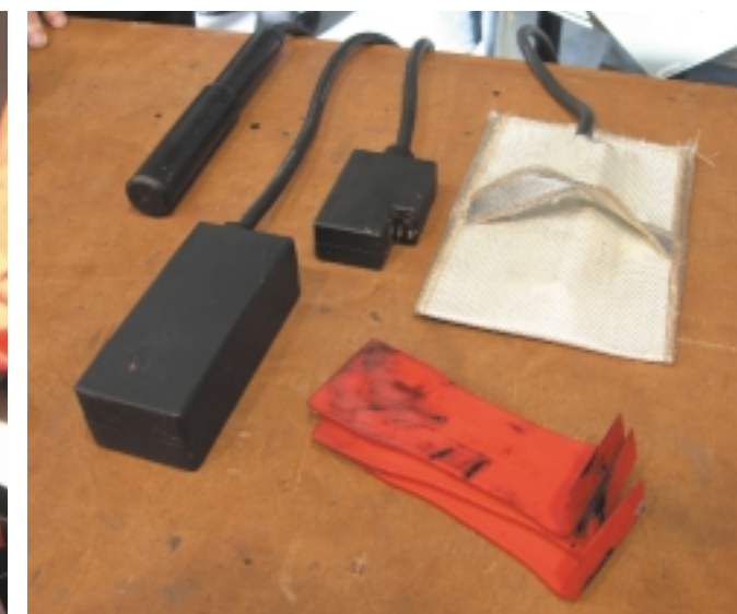
Części systemu AAT 33. Po lewej: generator o regulowanej mocy, z prawej: zestaw wymiennych elektromagnesów i (na pierwszym planie) kliny do podważania szyb
