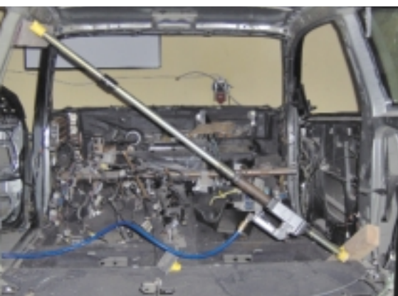
Sposób użycia pneumatycznego rozpieracza do prostowania zgiętych słupków
