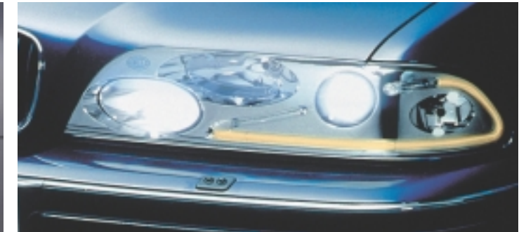
Pozycyjne lampy diodowe (z lewej) i światłowodowe dają nowe możliwości stylizacji nadwozia
