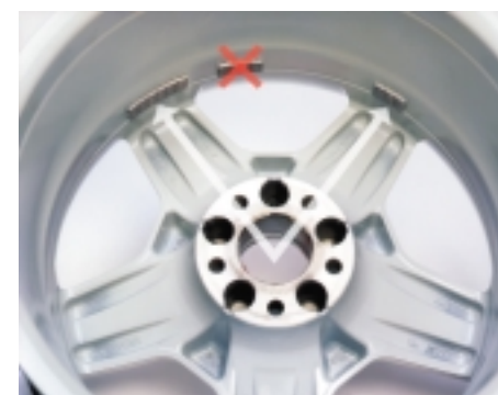
Funkcja Split, czyli zastąpienie jednej masy dwiema, ukrytymi za szprychami alufelgi
