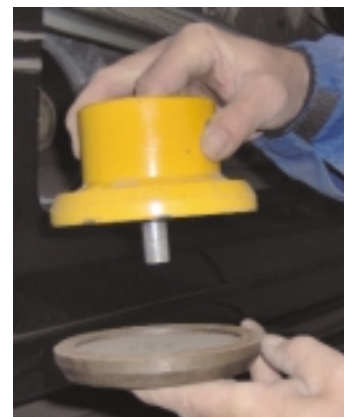
Wieloczęściowy zacpek do prostowania gniazd kolumn McPhersona. Najpierw łączy się tarcze oporowe z obu stron otworu, potem montuje hak, a do haka łańcuch ciągnący
