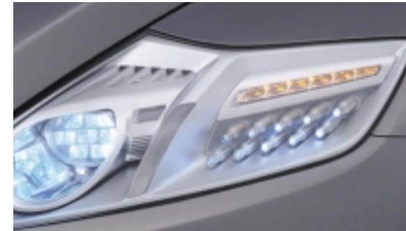
Pozycyjne lampy diodowe (z lewej) i światłowodowe dają nowe możliwości stylizacji nadwozia
