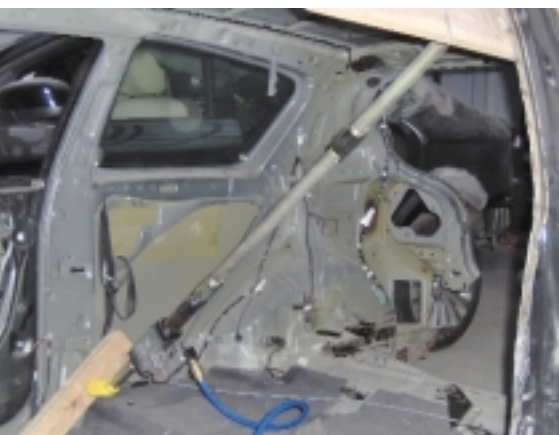
Uszkodzony słupek ze stali ultrawytrzymałej, przygotowany do całkowitej wymiany. Strażacy ratujący ofiary wypadków z tego rodzaju nadwozi muszą dysponować nożycami o specjalnie wzmocnionej konstrukcji
