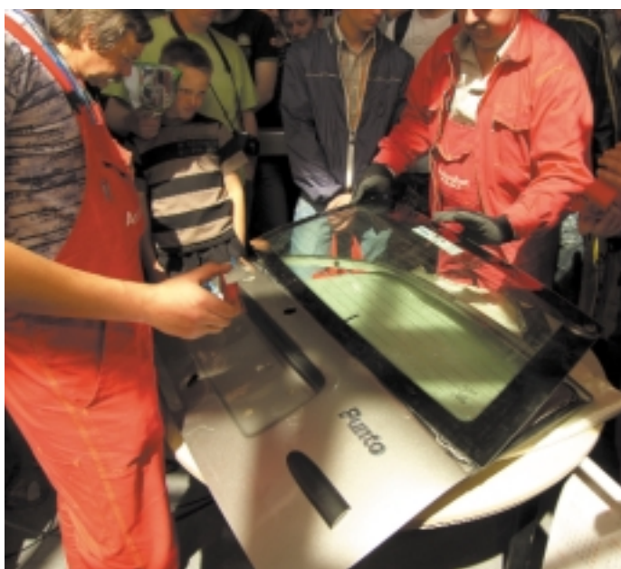
Jedna osoba przesuwa elektromagnes jak żelazko, po obwodzie szyby, a druga w tym czasie podważa krawędzie klinami. Cała operacja trwa kilka minut
