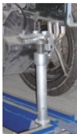
Blokowanie wyprostowanej już podłużnicy
