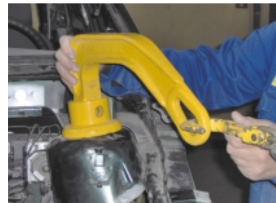
Wieloczęściowy zacpek do prostowania gniazd kolumn McPhersona. Najpierw łączy się tarcze oporowe z obu stron otworu, potem montuje hak, a do haka łańcuch ciągnący
