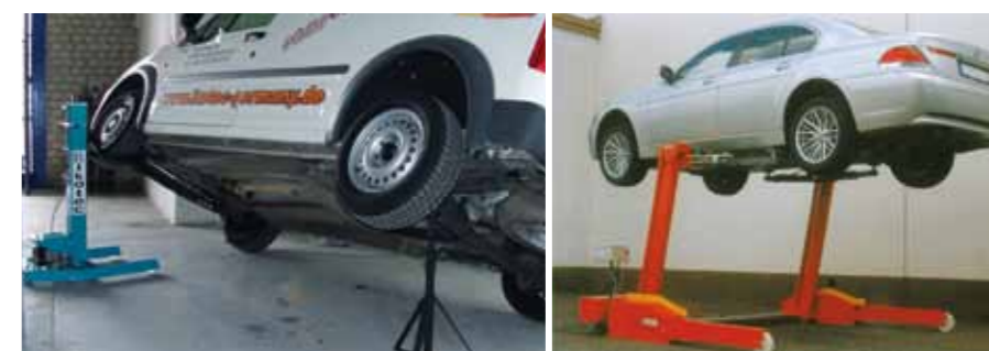
Podnośniki mobilne: jednokolumnowy Nordlift DHM-2000 z oferty firmy Elwico (z lewej), Ikotec minilift-2K przeznaczony do drobnych prac podwoziowych (w środku) oraz Finkbeiner – dwuramieniowy FHB (z prawej)
