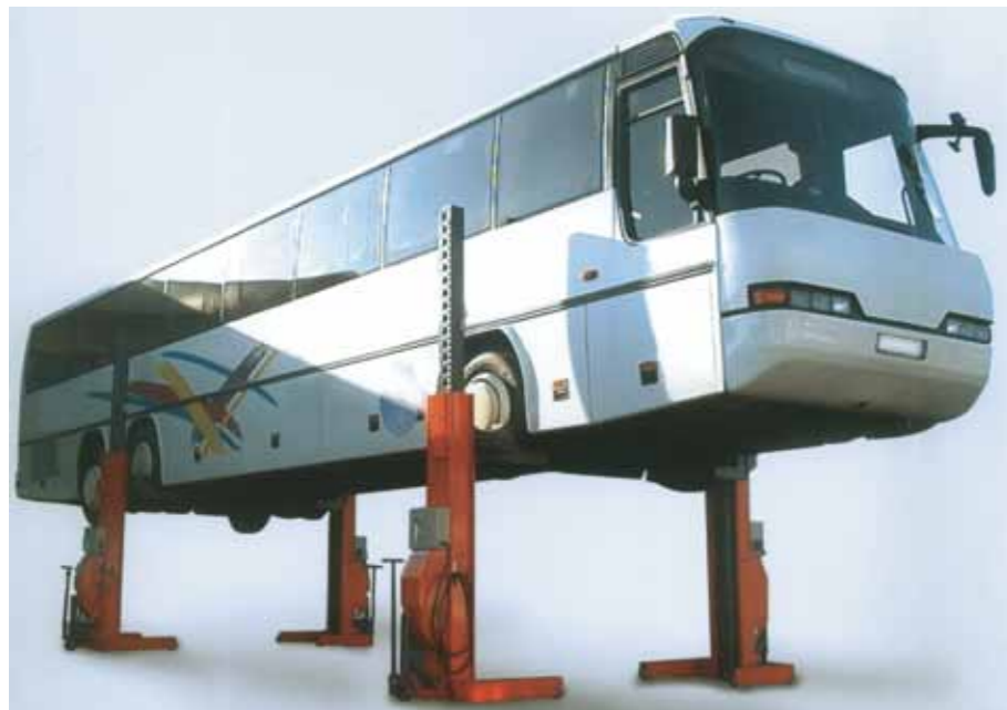
Zespół synchronizowanych podnośników mobilnych firmy Finkbeiner do ciężkich pojazdów użytkowych
