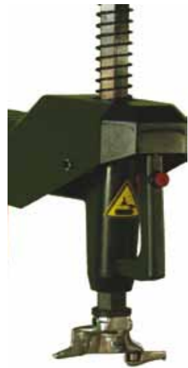
Stopka montażowa zamocowana na pionowym ramieniu montażownicy
