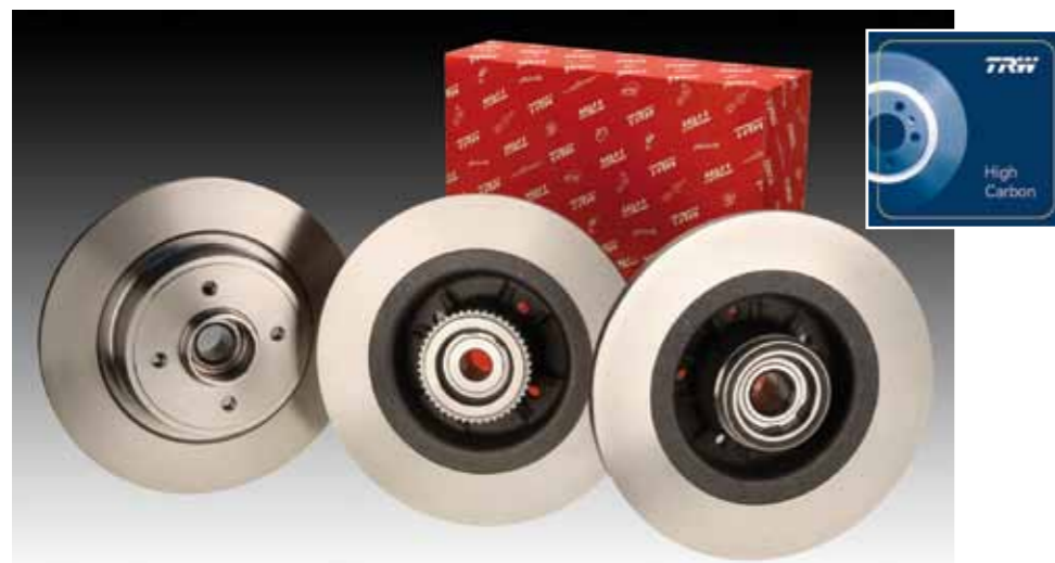
W tarczach lakierowanych ochronna powłoka pokrywa wszystkie powierzchnie oprócz roboczych. Tarczę wysokowęglową poznać można tylko po oznaczeniu High Carbon. Modernizacje konstrukcji polegają również na integrowaniu w tarczy takich funkcji piasty, jak łożyskowanie i czujnik ABS
