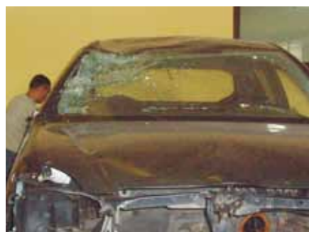
Naprawa tego uszkodzenia okazała się stosunkowo prosta, ponieważ żaden z elementów dachu nie został całkowicie zniszczony
