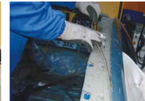
Po wycięciu wytloczki poszycia trzeba usunąć jej boczne ranty połączone z górnymi poziomymi belkami szkieletu
