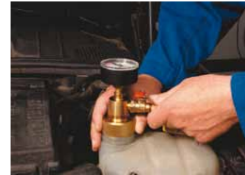
Uszczelnienie połączenia przyrządu ze zbiornikiem wyrównawczym
