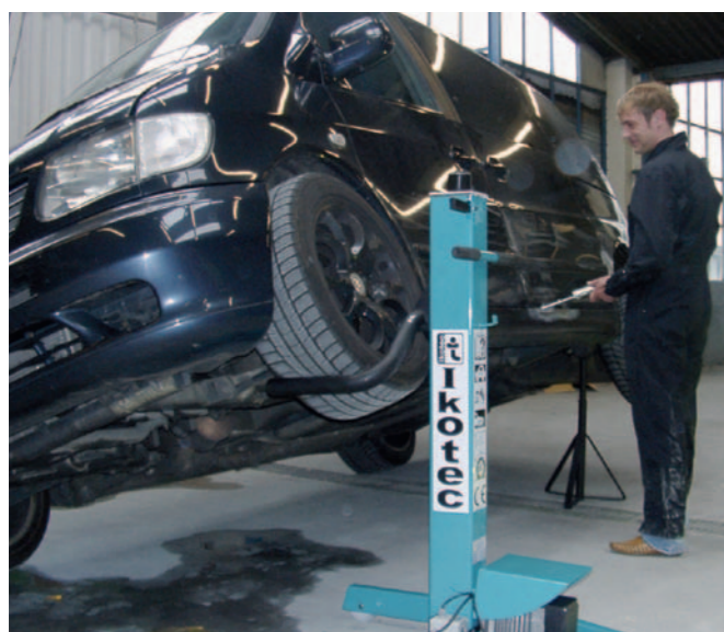
Przy jednostronnym podnoszeniu (z lewej i poniżej) wskazane jest użycie podpórki. Na pozostałych zdjęciach: funkcja żurawia i napinacza sprężyn
