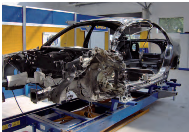
Uszkodzone nadwozie w trakcie naprawy
