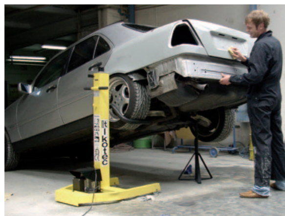
Przy jednostronnym podnoszeniu (z lewej i poniżej) wskazane jest użycie podpórki. Na pozostałych zdjęciach: funkcja żurawia i napinacza sprężyn
