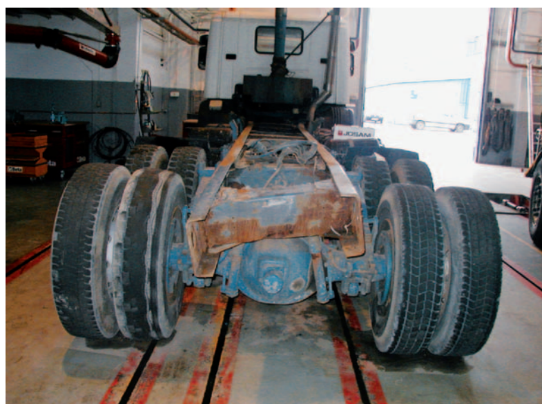
Widok ramy pojazdu ciężarowego po poważnej kolizji drogowej
