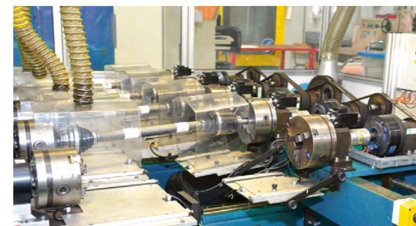
BADANIE KOMPLETNYCH PÓŁOSI NAPĘDOWYCH NA STANOWISKU TESTOWYM
