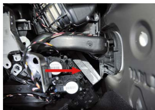
FILTR KABINOWY CHRONI RUCHOME ELEMENTY MECHANICZNE INSTALACJI PRZED ZANIECZYSZCZENIAMI
