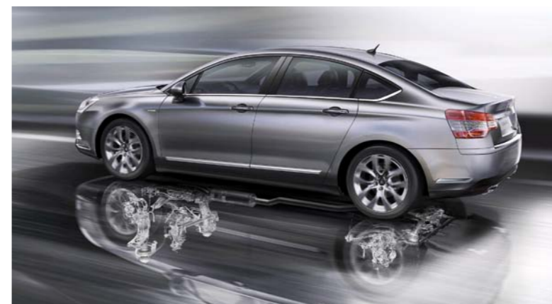
W MODELU C5 (PO 2007 ROKU) CITROËN ZAOFEROWAŁ DWA WERSJE ZAWIESZENIA. PODSTAWOWE NIE MA HYDROPNEUMATYKI, W KTÓRĄ WYPOSAŻONA JEST ODMIANA DROŻSZA
