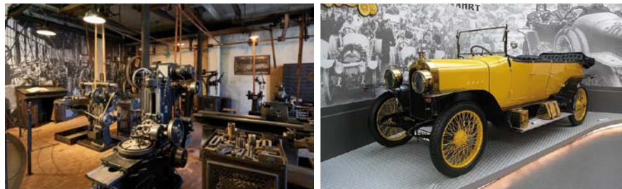
Fragment stałej ekspozycji w August Horch Museum w Zwickau: pieczołowicie odtworzony zakład wytwórczy ze sprawnymi maszynami oraz samochód Audi Type C Alpensieger z 3,5-litrowym, 4-cylindrowym silnikiem rzędownym i mocą 35 KM
